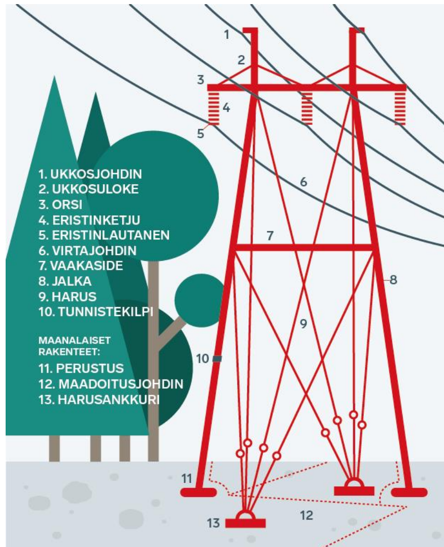
Kuva 13. Suurjännitejohtopylvään pääosat [35].
