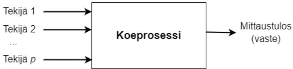
Kuva 1. Yksinkertaistettu kuvaus koesuunnitteluun perustuvasta koejärjestelystä.
