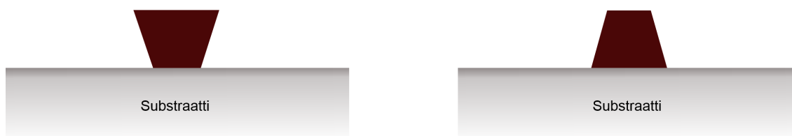
Kuva 3.3. Havainnollistava kuva kahdesta mahdollisesta resistin sivuseinämästä. Vasen puoli kuvastaa tyypillistä ylileikkausta. Oikea puoli kuvaa ns. alileikkausprofiilia. Seinämien kaltevuutta on liioiteltu kuvaa varten.
