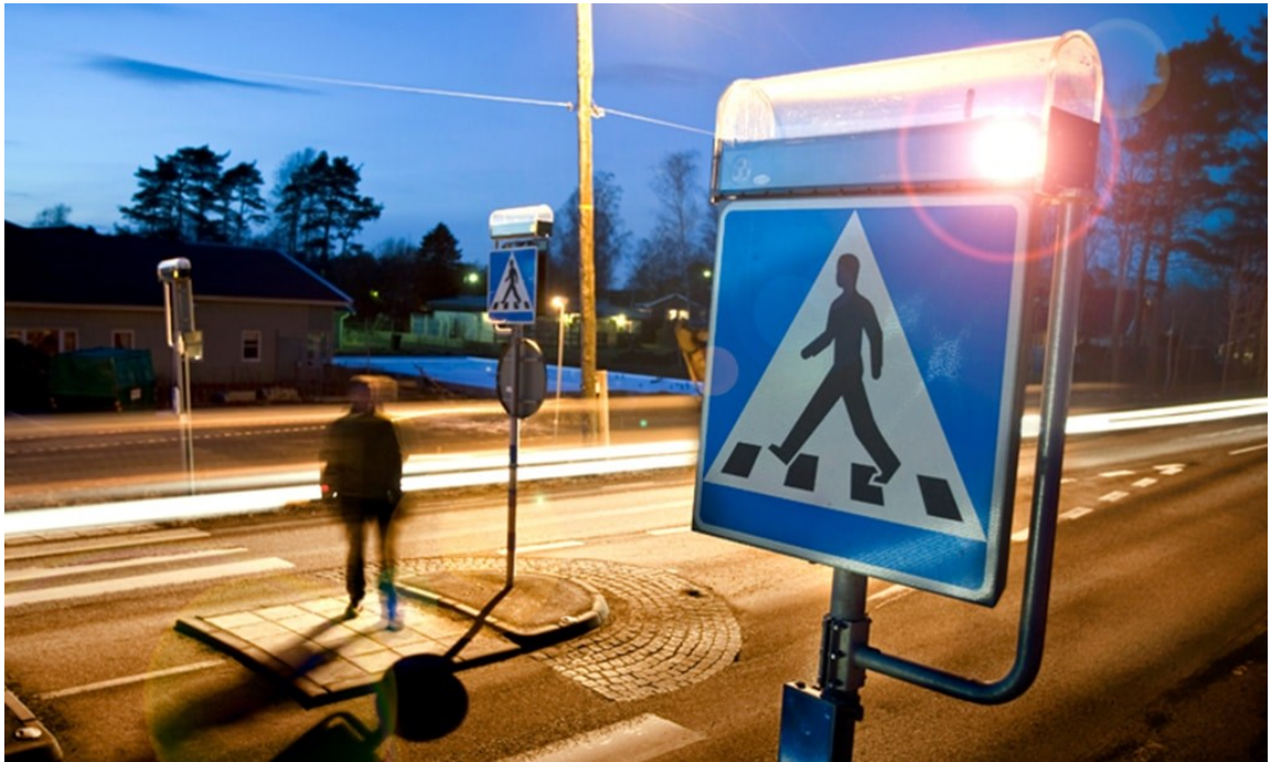
Kuva 5. SeeMe-suojatien turvajärjestelmä (Amparo solutions 2023).
