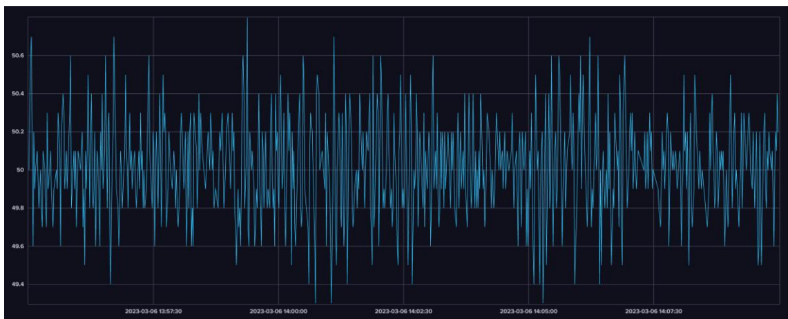
Kuva 10: Generaattorin tuotetun sähkön taajuus (Hz)
