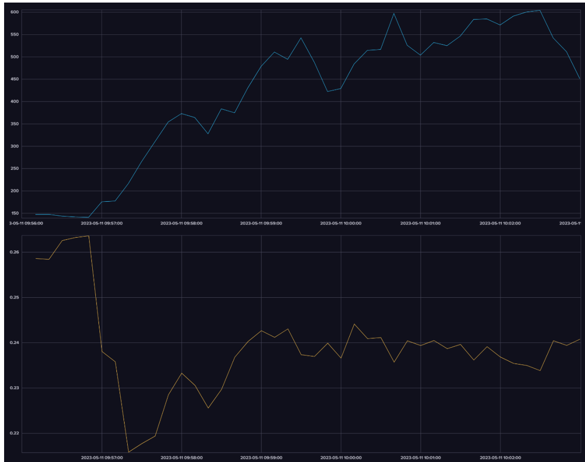
Kuva 43: Laitoksen teho (kW) ja tehokkuus (L/kWh)
