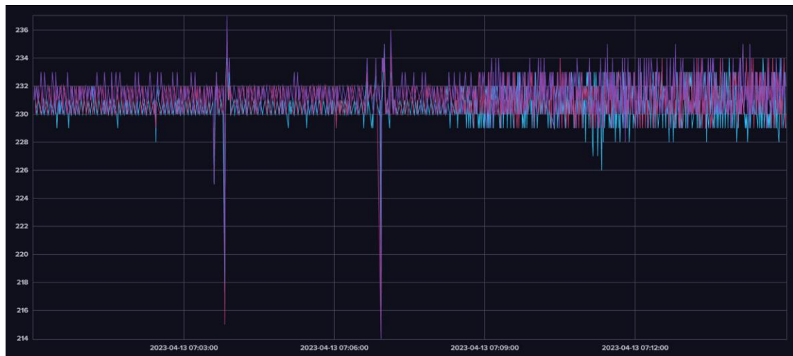
Kuva 33: Jännitteen heittely laitoksen käynnistysvaiheessa
