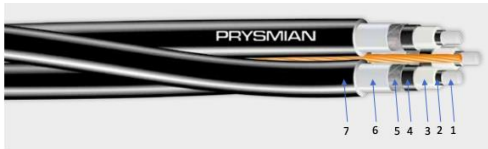
Kuva 4. Esimerkki kaapelin rakenteesta. [6 s. 313][11, muokattu] 1) johdin, 2) johdinsuoja, 3) eristys, 4) hohtosuoja, 5) paisuntakerros, 6) kosketussuoja, 7) vaippa.
