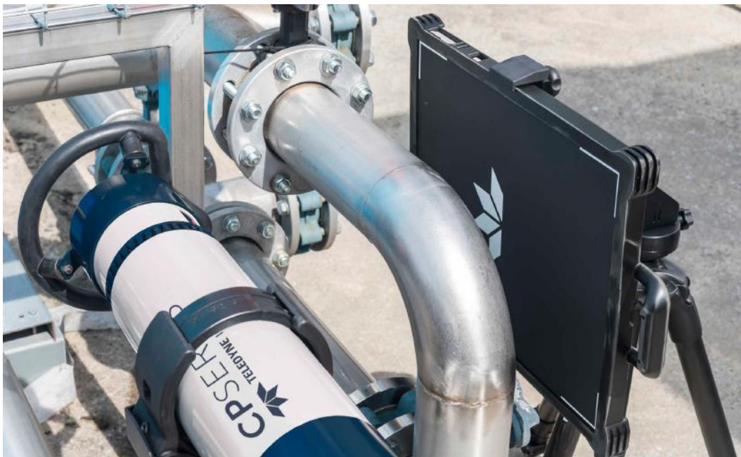
Kuva 4 Hitsaussaumojen tarkastusta digitaalisella radiografialla, kun säteilylähteenä käytetään röntgenputkea. (I.TEC 2023)
