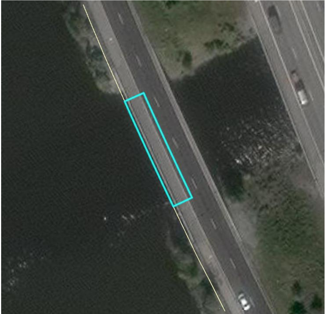
Kuva 25 Tarkkuuspaikannusviivan projisoiminen tunnistetun ajolinjan perusteella. (Esri Inc., 2023)
