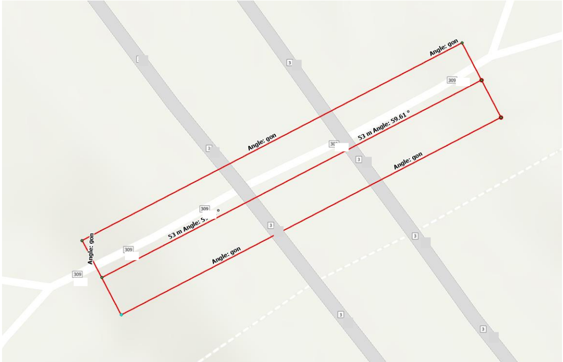
Kuva 11 Suuntaviivan molemmille puolille piirretyt ajolinjan viivat geometriapisteiden selvittämistä varten. Kuvasta poistettu teiden numerot. (Esri Inc., 2023)
