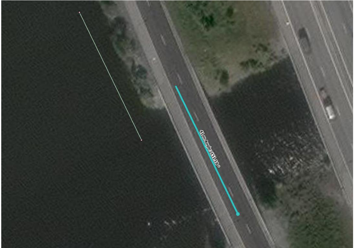
Kuva 21 Suuntaviivapisteiden perusteella piirretty viiva ja samansuuntainen viiva keskipisteen päälle siirrettynä. (Esri Inc., 2023)
