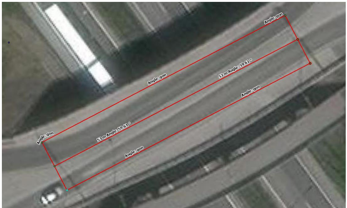
Kuva 12 Suuntaviiva ja geometriapisteiden selvittämistä varten piirretyt tukiviivat ilmakuvassa esitettynä. (Esri Inc., 2023)
