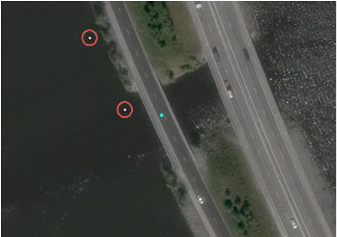
Kuva 20 Taitorakennerekisterissä annetut suuntaviivapisteen ja sillan keskipistegeometria. (Esri Inc., 2023)
