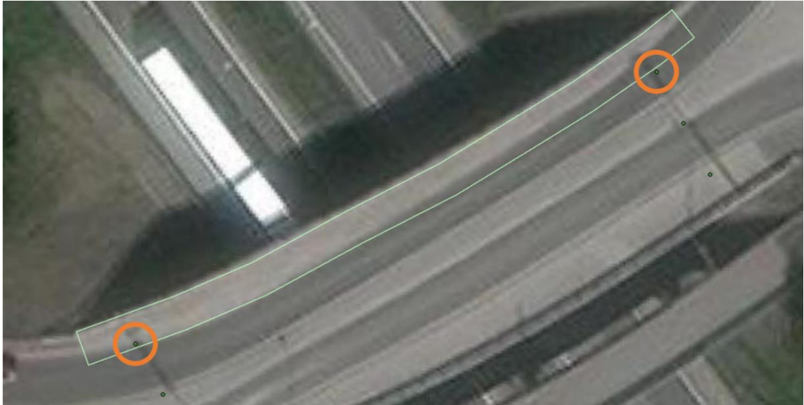
Kuva 14 Geometriapisteistä lasketut ajolinjan pisteet ja ilmapuuvaa digitoitu ajolinjatieto. (Esri Inc., 2023)
