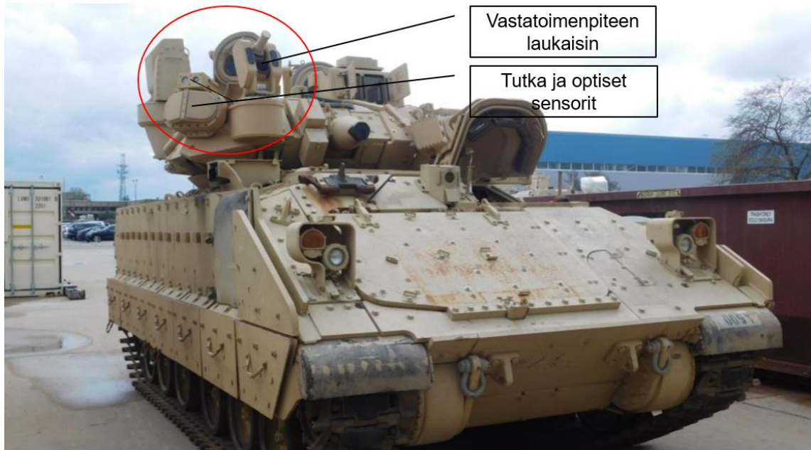
Kuva 5. M2 Bradley rynnäköpanssarivaunun tykkitorniin sijoitettu, Israel Military Industries:n suunnittelema aktiivinen suojausjärjestelmä, Iron Fist. Mukailtu lähteestä: [16]
