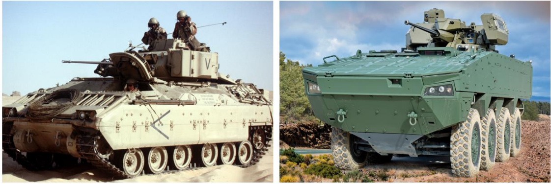
Kuva 2. Telaketjuilla kulkeva, 25 mm konetykillä varustettu IFV, M2 Bradley [5] (vas.) ja keskiraskaalla konetykillä varustettu, renkailla liikkuva Patria AMV 8x8. (oik.) [6]
