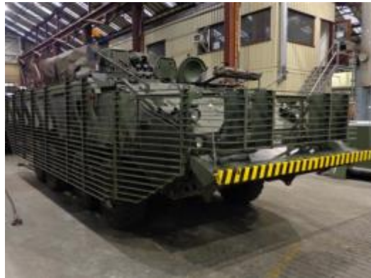
Kuva 15. Kehikkopanssarointi Belgialaisen Piranha AIV:n ympärillä. Kuva: [40]
