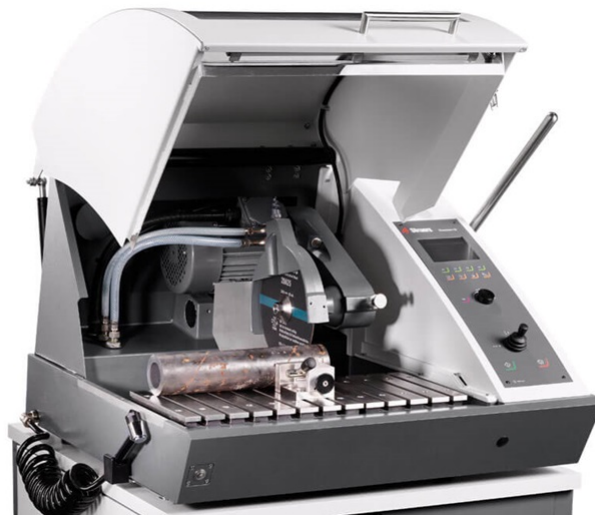
Kuva 2.1. Leikkauskone ja siihen kiinnitetty putkimainen näyte [5].
