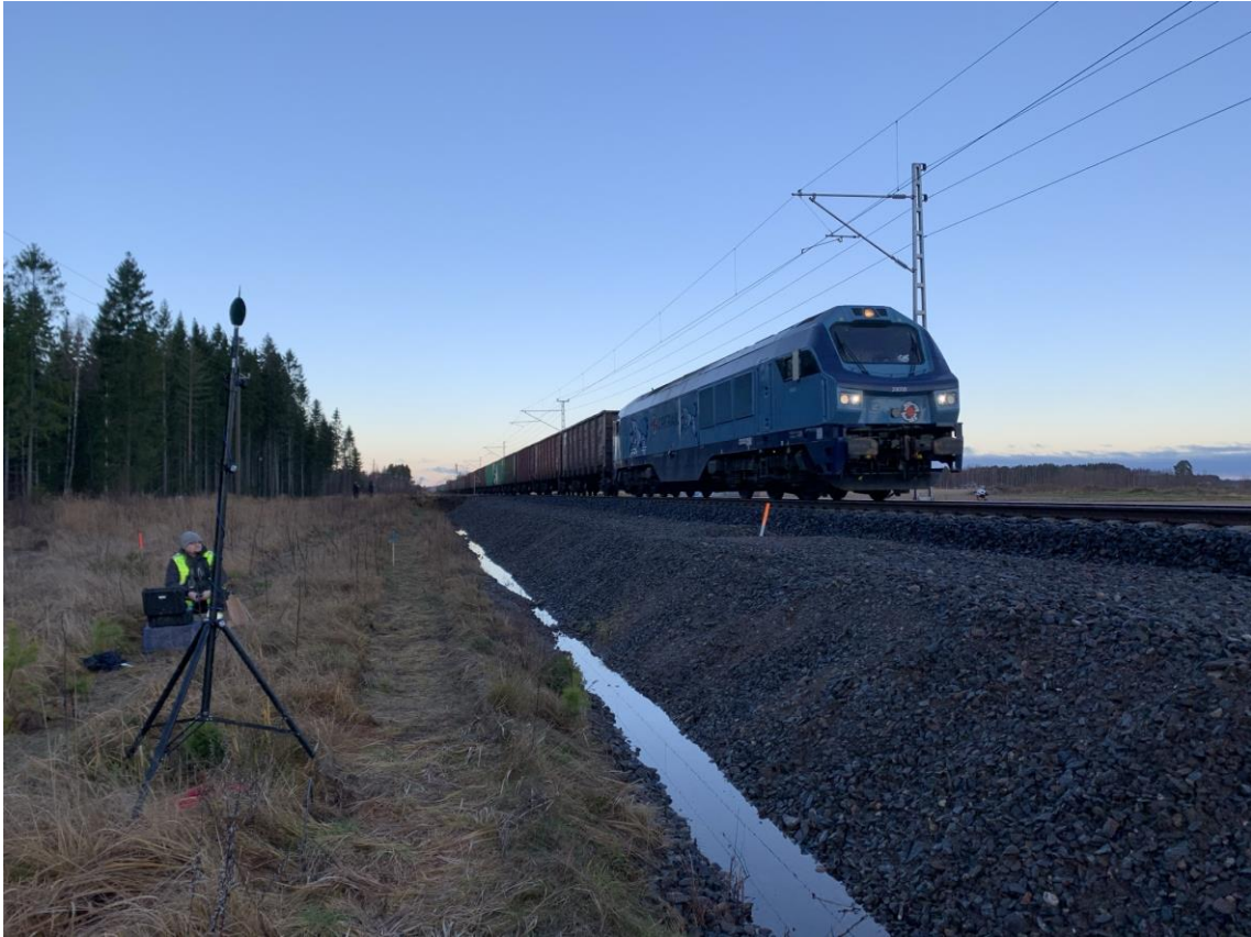
Kuva 6.4. Raideliikennemelun mittausta. Kuvälähde: A-Insinöörien kuva-arkisto, kuvaaja Timo Huhtala.
