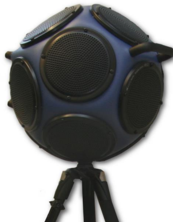
Kuva 3.25. Ilmaääneneristävyyden mittauksissa äänilähteenä käytettävä ympärisäteilevä kaiutin. Kuvalähde: A-Insinöörien kuva-arkisto.
