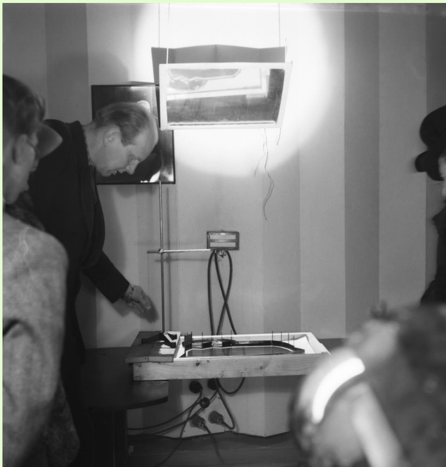
Akustiikan asiantuntija Paavo Arni (1905–1969) esittelee vuonna 1946 lehdistölle ”Arnin akvaariota” eli vesimallia, jota käytettiin sittemmin keskeytyneessä hankkeessa Kaartin maneesin muuttamiseksi Yleisradion konserttisaliksi. Mallilla yritettiin tutkia, kuinka ääni etenee ja heijastuu tilassa. Kuvälähde: Yleisradion arkisto, kuvaaja Ruth Träskman 19.11.1946.
