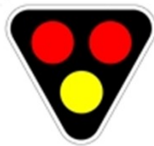
Kuva 19. Kolmihaarainen raitiovaunuvalo, jota käytetään ajoneuvoliikenteen pysäyttämiseen. (Tampereen Raitiotie Oy 2021c)
