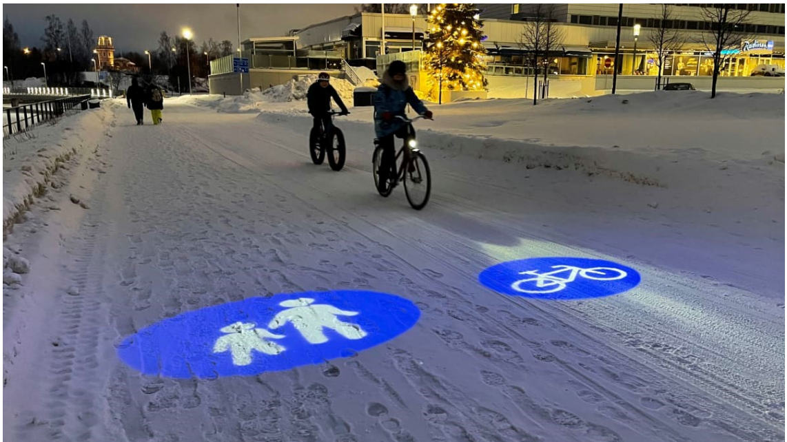
Kuva 44. Projektorivalaisimilla voidaan lumiaikaan osoittaa kulkumuotojen paikat väylällä. (Yleisradio 2020)
