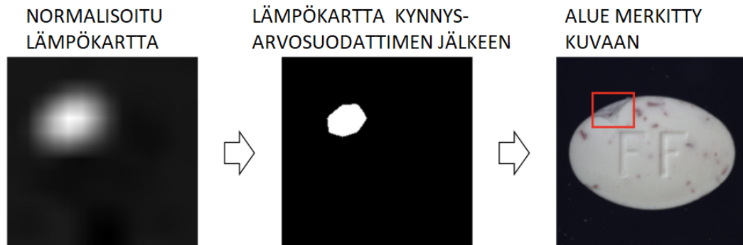
Kuva 29. Lämpökartan perusteella tehtävä vian merkintä, muokattu lähteestä [44]
