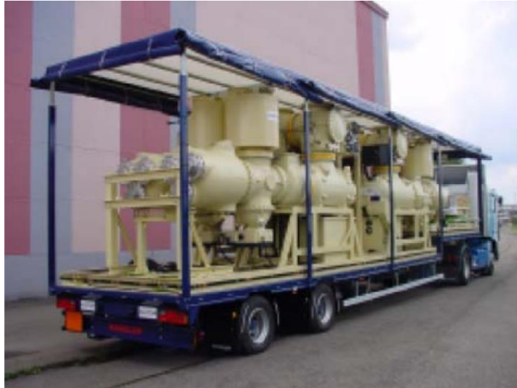
Kuva 32. Siirrettävä 72,5 kV:n kytkinlaitos [31].
