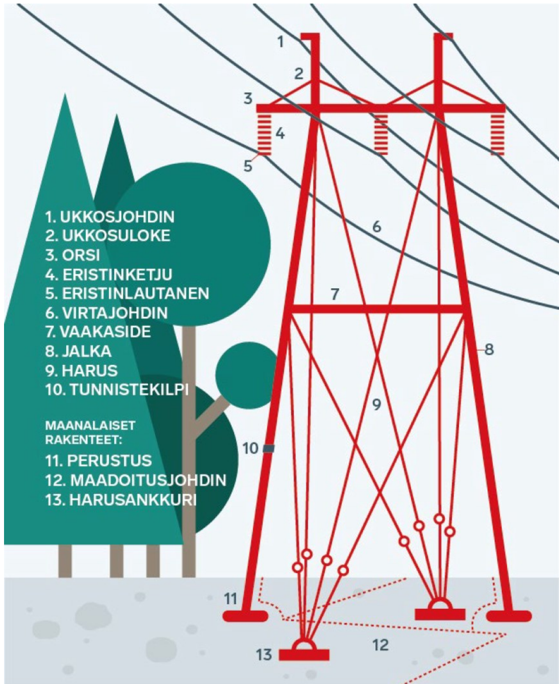
Kuva 1. Tavanomainen 110 kV voimajohto ja sen komponentit osineen [18.]
