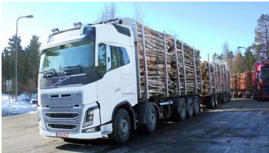
Kuva 9. Moilaspoikien HCT-yhdistelmä, joka toimii joko 90-tonnisena terminaaliyhdistelmänä tai 84-tonnisena metsäautona [24]
