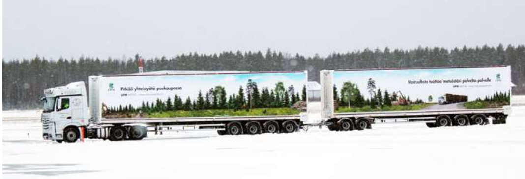
Kuva 8. Kuljetusliike Kalevi Huhtala Oy 100 t hakeyhdistelmä. Yhdistelmän kokonaispituus on 34 m ja se koostuu 3-akselisesta puoliperävaunun vetoautosta, 4-akselisesta puoliperävaunusta sekä 5-akselisesta perävaunusta. [24]
