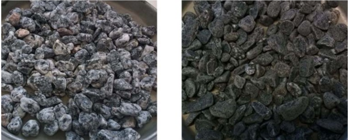
Kuva 10. Kiviaineksen TC graniittinen (vasemmalla) ja liuskeinen osa (oikealla) (Kalliainen, et al. 2017, s.25).
