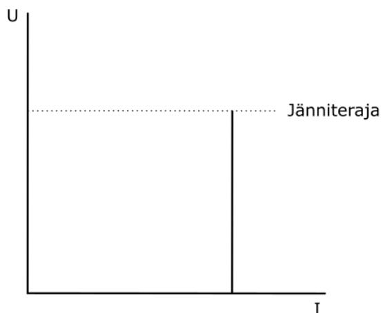
Kuva 4. Käytännön vakiovirtalähteen ominaiskäyrä [1]
