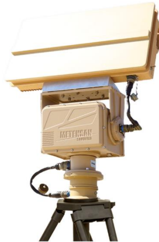
Kuva 10. Meteksan-yhtiön valmistama Retinar Far-AD-pulssitutka [57, © Meteksan Savunma]
