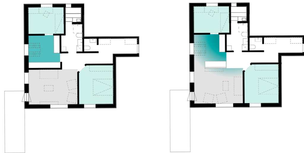
Kuva 6.2.2.B: Erillisistä tiloista avoimeksi (1:150). Vasen pohjapiirros on alkuperäinen ja oikeanpuoleinen on tästä muokattu, vaihtoehtoinen versio, jossa asuntoon on toteutettu erilliskeittiön sijasta keittiön ja olohuoneen yhdistävä avoin päätila. Vaalea harmaa kuvaa oleskelutilaa ja tumma turkoosi ruuanlaiton tilaa: raja oleskelun ja ruuanlaiton välillä on avoin tai suljettu. Vaalea turkoosi kuvaa suljettavia makuuhuoneita. Eteiset, kylpyhuoneet ja wc:t esitetään valkoisella.
