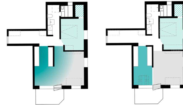
Kuva 6.2.2.A: Avoimesta tilasta erillishuoneiksi (1:150). Vasen pohjapiirros on alkuperäinen ja oikeanpuoleinen on tästä muokattu, vaihtoehtoinen versio, jossa keittiö on erotettu olohuoneesta. Vaalea harmaa kuvaa oleskelutilaa ja tumma turkoosi ruuanlaiton tilaa: raja oleskelun ja ruuanlaiton välillä on avoin tai suljettu. Vaalea turkoosi kuvaa suljettavia makuuhuoneita ja turkoosi viivarasteri toissijaista varastotilaa. Eteiset, kylpyhuoneet ja wc:t esitetään valkoisella.
