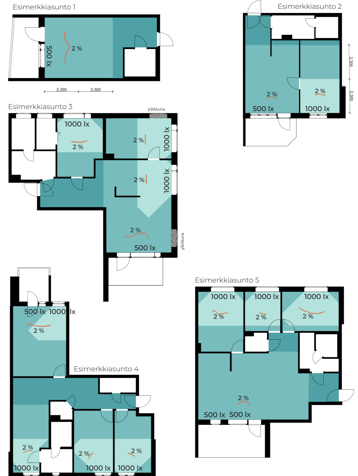
Kuva 4.1.1.B: Viidestä esimerkkiasunnosta tehdyt luonnonvaloanalyysit. Turkoosit vyöhykkeet kuvastavat kirjallisuuteen perustuvia 2,3 m ja edelleen 4,6 m etäisyyksiä ikkunasta. Oranssit käyrät kuvastavat luonnonvalosimulointien mukaisia 2 % hyvän päivänvalosuhteen rajoja.
