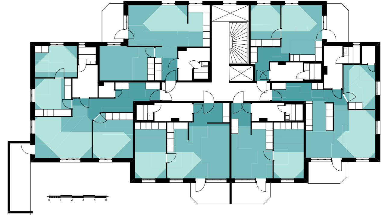
Kuva 4.1.1.C: Esimerkki kerroskehien luonnonvalovöhyketarkastelusta (1:200). Vaalein vöhyke edustaa hyvää, keskimäärin tyydyttävää ja tummin huonoa luonnonvalovöhykettä taulukon 4.1.1.C mukaisesti. Valkoiset alueet on jätetty vöhyketarkastelun ulkopuolelle ei-asuinhuoneina. Kaikkien kymmenen kohdekiinteistön tyyppisten kerroskehien vöhyketarkastelut on esitetty kokonaisuudessaan liitteessä 3.
