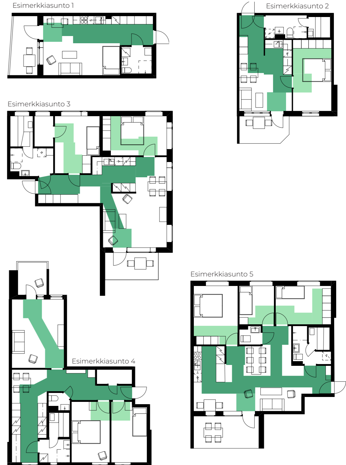
Kuva 4.1.2.C: Esimerkkiasuntojen (ks. taulukko 4.1.A) liikenneala-analyysit (1:150). Tumma vihreä kuvastaa ensisijaista liikennealaa, keskivihreä toissijaista ja vaaleanvihreä huoneiden sisäistä liikennealaa. Valkoinen lattiapinta-ala jää teholliseksi hyötyalaksi kalustettavuutta varten.
