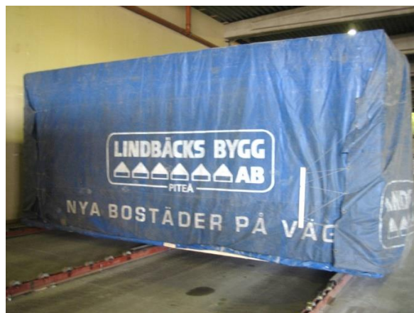
Kuva 10. Tilaelementin kuljetuksen aikainen uudelleen käytettävä suojaus. (Puuinfo 2020)
