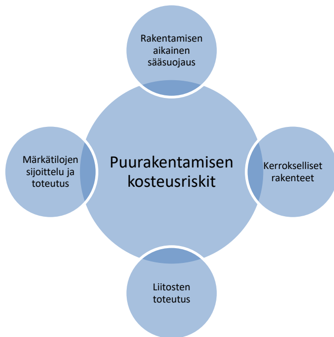
Kuva 17. Korkean puurakentamisen keskeiset kosteusriskit
