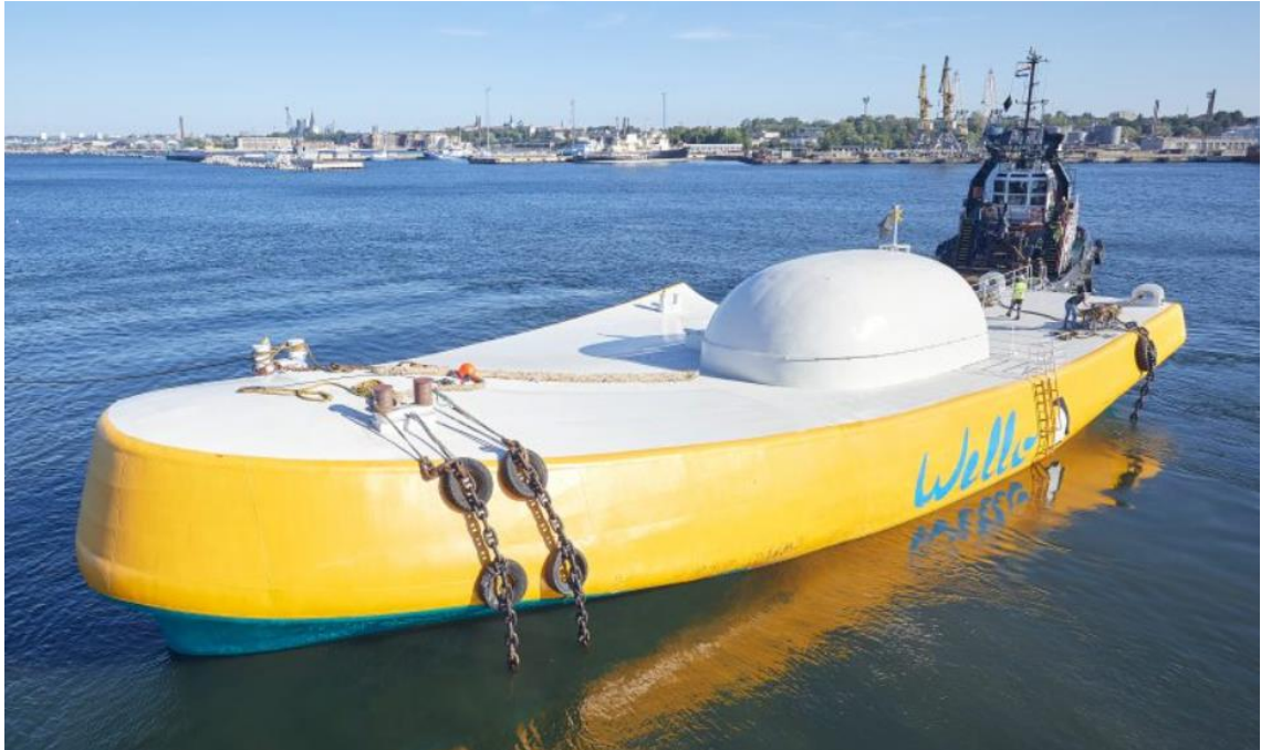
Kuva 16. Wello Oy:n Pingviini aaltoenergiamuuntaja (Wello Oy 2021)
