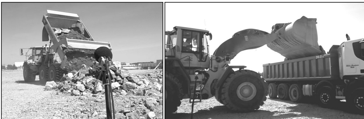
Kuva 4. Ympäristömelumallinnuksen lähtötiedoiksi suoritettiin melumittauksia, joiden avulla määritettiin eri melulähteille melupäästöt.
