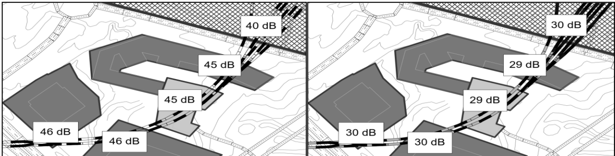
Kuva 3. Vasemmalla arvioidut runkomelutasot alimmassa kerroksessa ilman vaimennusta ratarakenteessa ja oikealla eri alueille mitoitetun vaimennuksen kanssa.
