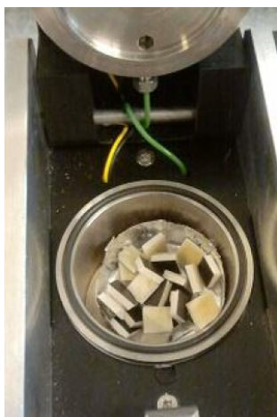
Kuva 1. Hienonnettu PVC-mattonäyte mikrokammiossa.
