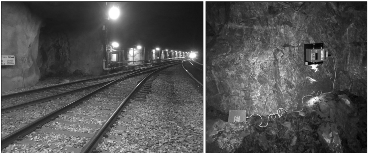
Kuva 2. Vasemmalla kuva referenssimittauksista olemassa olevan metroradan alueella, joita tehtiin mm. vaihdealueilla. Oikealla kuva louhintojen yhteydessä tehdyistä referenssimittauksista, joiden avulla selvitettiin siirtofunktio selvitysalueen maaperässä.
