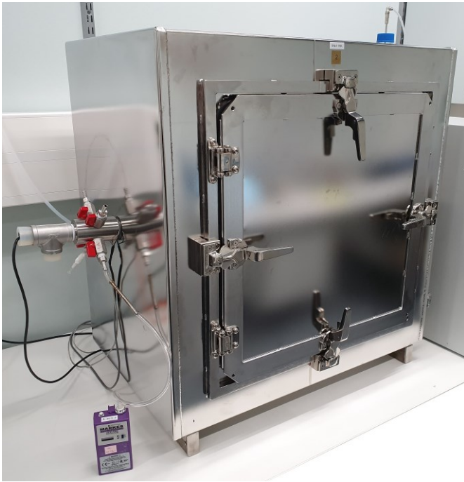
Kuva 3. Standardin ISO 16000-9 mukainen VOC-emissionäytteenotto testikammioista.
