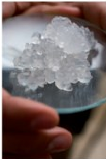
Kuva 4. Nanosellugeeliä eli nanosellun vesisekoite [4 s.5441]
