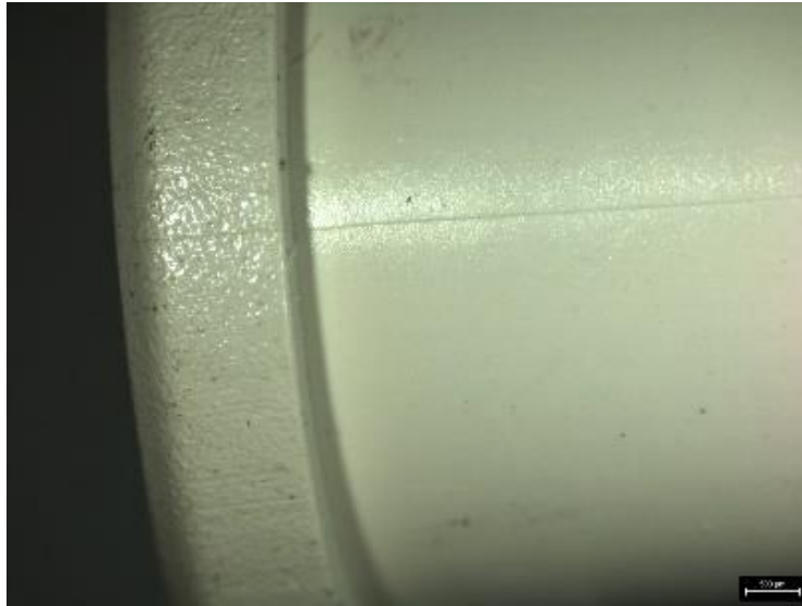
Kuva 16, Materiaali 1:stä valmistetun hylsyn sivusta otetusta kuvasta yhtymäsauman voimakkuus ja pituus on selkeästi havaittavissa.
