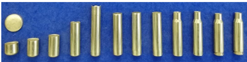
Kuva 1, Messinkisen patruunahylsyn valmistuksen välivaiheet.
