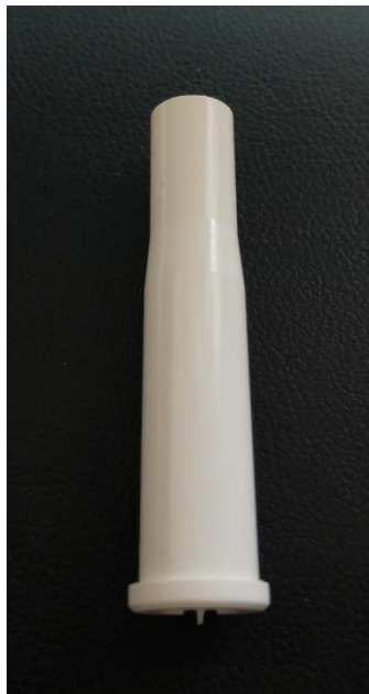
Kuva 17, Normaalissa valaistuksessa otetussa valokuvassa yhtymäsauma ei ole havaittavissa.
