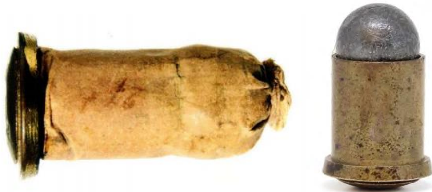
Kuva 4a (vasen), Pauly vuonna 1808 kehittämä paperipatruuna sekä kuva 4b (oikea) Pauly jatkokehittämä messinkirunkoinen patruuna vuodelta 1812. [5, 6]
