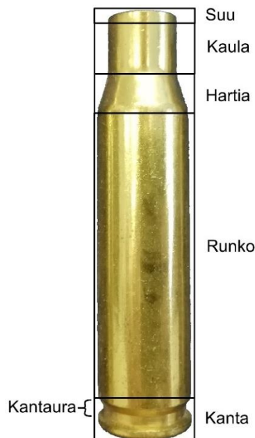
Kuva 8, Moderni kiväärihylsy, kaliiperi 308win, sekä sen geometriset piirteet korostettuina sekä nimettyinä. Lähde: Toimeksiantajan arkisto
