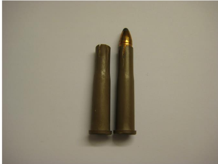
Kuva 12, Kuvankaappaus toimeksiantajan arkistoidusta testi-raportista. ”26.6.2012 – Uusi testierä ruskeita muovihylsyjä. Hylsyjä ei päästy ampumaan, koska kaula halkesi luotia asettaessa.”
