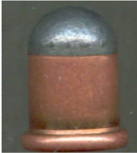
Kuva 6, Flobertin 6 mm patruuna. Patruuna oli seinämiltään venytetty nallikuppi, joka oli täytetty nallimassalla ja kiilattu 6 mm lyijykuulalla tiiviiksi [8].
