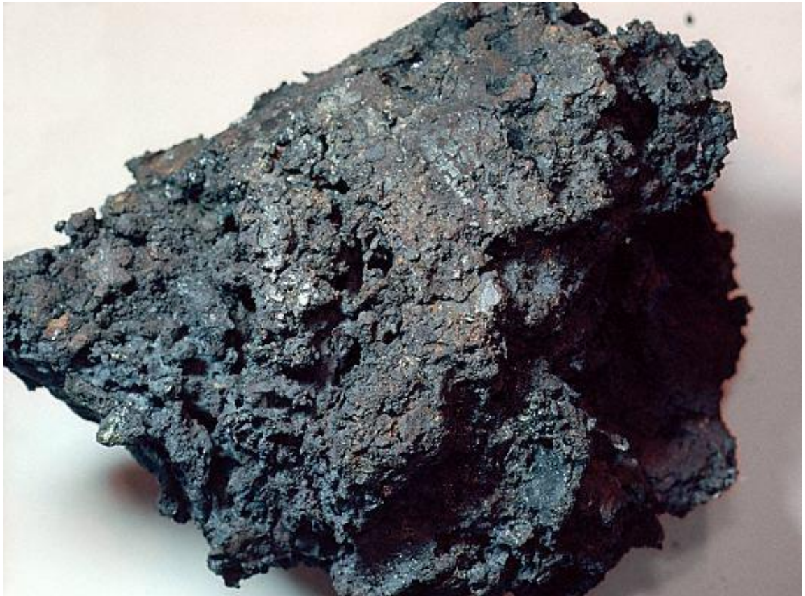
Kuva 6. Rautamalmin pelkistysprosessin tuloksena syntynyt bluumi (34)
