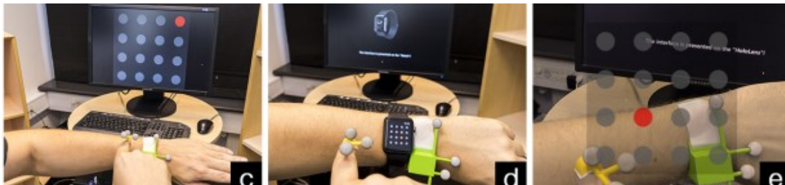
Kuva 10. OptiTrack-liikkeentunnistusjärjestelmän avulla käyttäjä kartoittaa pisteitä kuvassa c näytöltä käteen, kuvassa d älykellosta käteen ja kuvassa e AR-laseista käteen. (Bergström-Lehtovirta, Hornbæk ja Boring, 2018).
