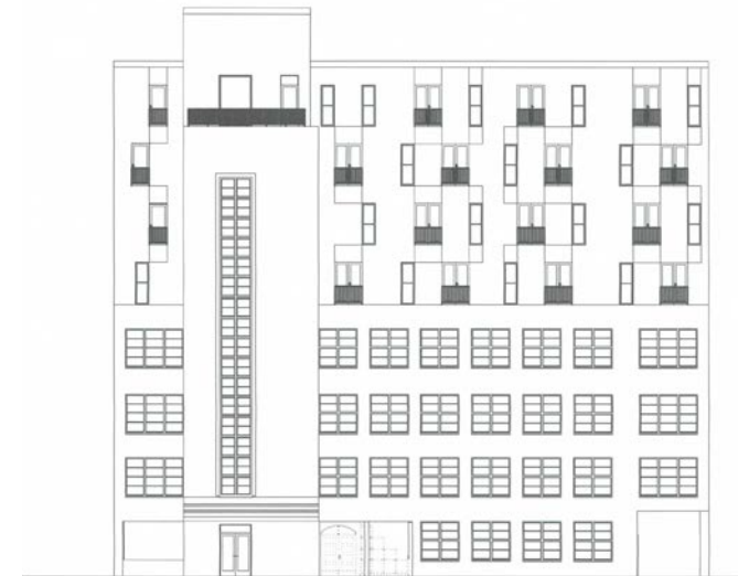
Ikkunoiden välillä paloetäisyys 1 metri kerrosten välillä huomioiduna. Ikkuna pinta-ala huoneistoihin jää liian vähäiseksi.
