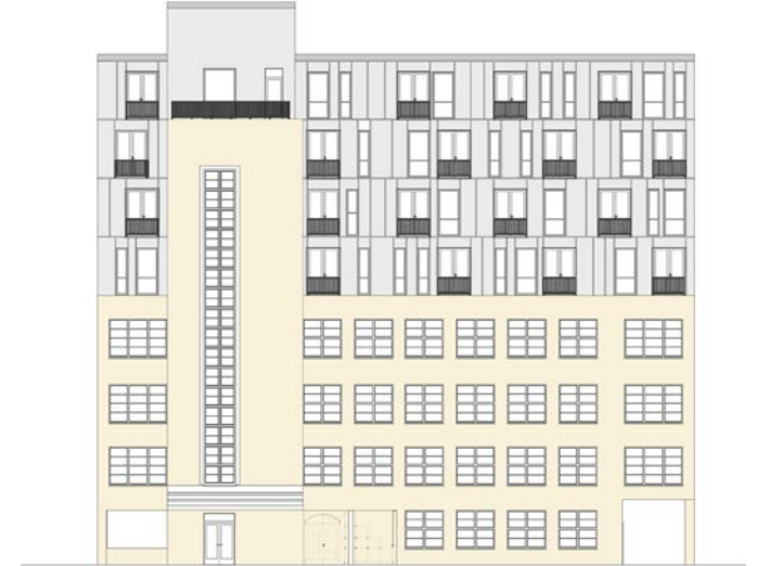
Raskalasiiniparvekkeisiin lisätty kehysaihe palosuojaukseksi ja riittävän ikkunapinta-alan aikaan saamiseksi.
