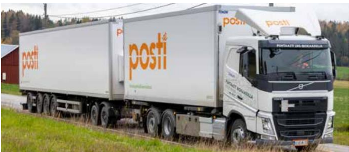
Kuva 3. Posti Kuljetus Oy:n pitkä täysperä 7,7 + 15,5–metrisillä kuormatiloilla.
