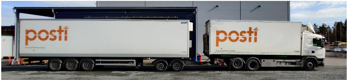
Kuva 2. Posti Kuljetus Oy:n täysperäyhdistelmä 7,7 m + 13,6 m kuormatiloilla.
