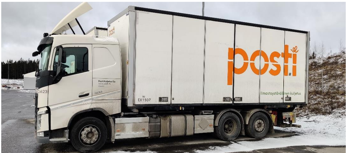
Kuva 8. HCT yhteensopiva täysperävaunun vetoauto Volvo FH 500 (206623). Päällirakenteena EX1507 jalkalavakontti.
