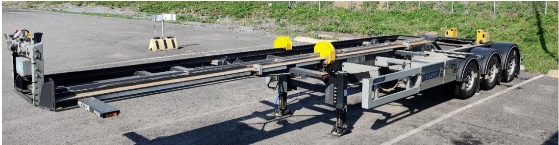
Kuva 13. AB-tuplayhdistelmän linkkivaunu MB20208 ilman jalkalavakonttia eli ns. "raamina".
