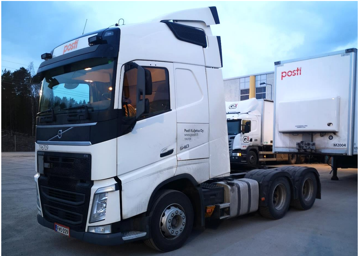
Kuva 9. HCT yhteensopiva (A-tupla) puoliperävaunun vetoauto Volvo FH 540 (196709). Takana irtikytkettynä A-tuplan etuvaunu M2004.
