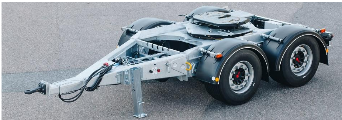
Kuva 12. VAK Oy:n valmistama apuvaunu eli dolly. (VAK Oy, 2021a)
