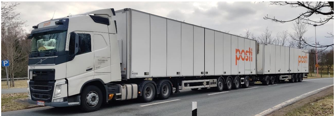
Kuva 4. Posti Kuljetus Oy:n A-tupla 15,5 + 13,6–metrisillä kuormatiloilla.
