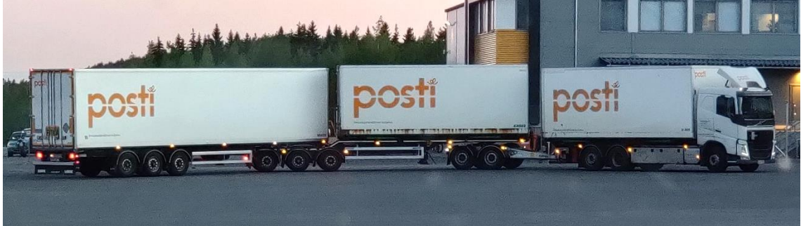
Kuva 5. Posti Kuljetus Oy:n AB-tupla 7,7 + 7,7 + 13,6 metrin kuormatiloilla.
