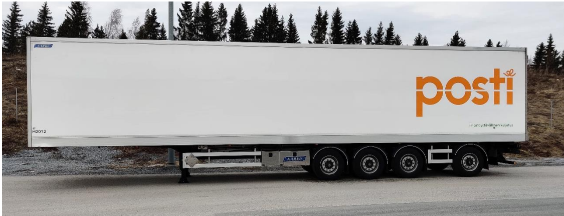
Kuva 11. HCT-käyttöön soveltuva, ohjaavalla taka-akselilla varustettu 15,5 metrin puoliperävaunu M2012.
