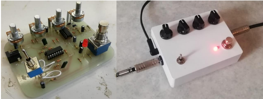
Kuva 19. Piirilevy komponentteineen sekä valmis efektipedaali
