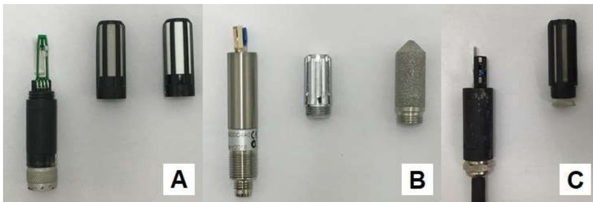
Kuva 1. Kapasitiivisten kosteusantureiden mittapäät ja suodatinvaihtoehdot: A) Rotronic HC2-S, B) Vaisala HMP110 ja C) Vaisala HMP230.
