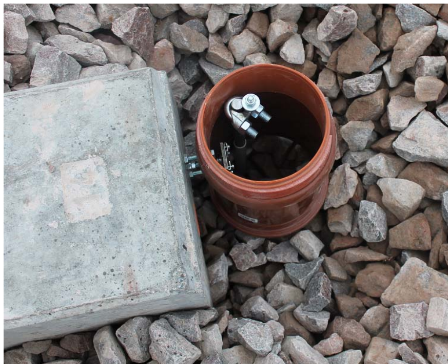
Kuva 12. Pölkyn pystysuuntaista liikettä mittaavan anturin kiinnike ja sen referenssitasona toimiva kairatanko suojuksineen.
