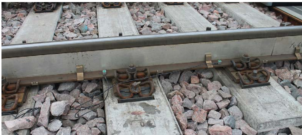
Kuva 16. Kiihtyvyyssanturimittaus vaihteen kielisovitusalueella.
