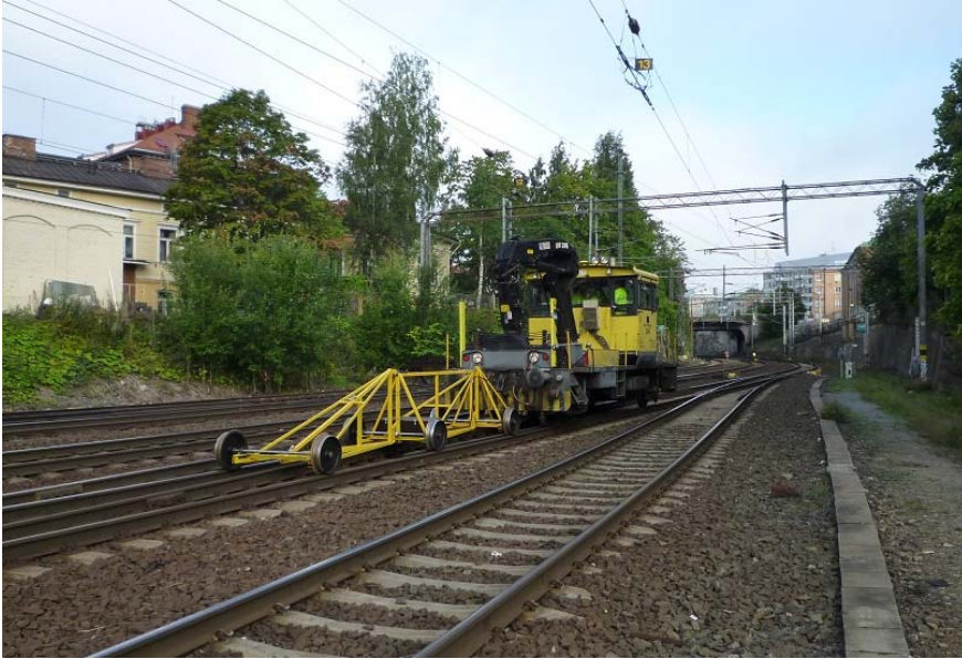
Kuva 10. TTY:llä kehitetty radan palautuvaa painumaa mittaava laite.
