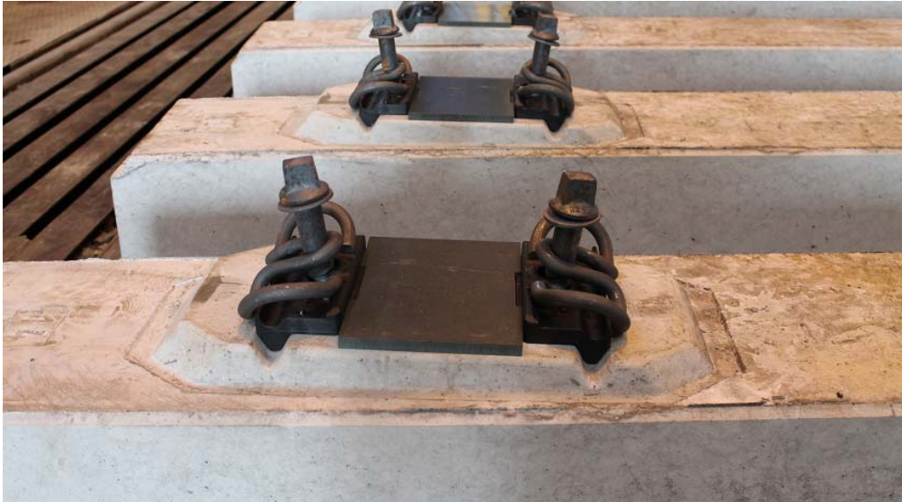
Kuva 22. Vaihdepölkky, johon on valettu kallistettu korokeosa.
