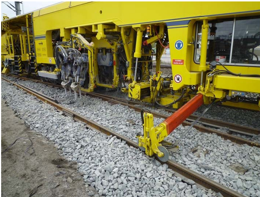
Kuva 15. Vaihteentukemiskone tukemassa risteyskärkeä Viinikan ratapihalla.
