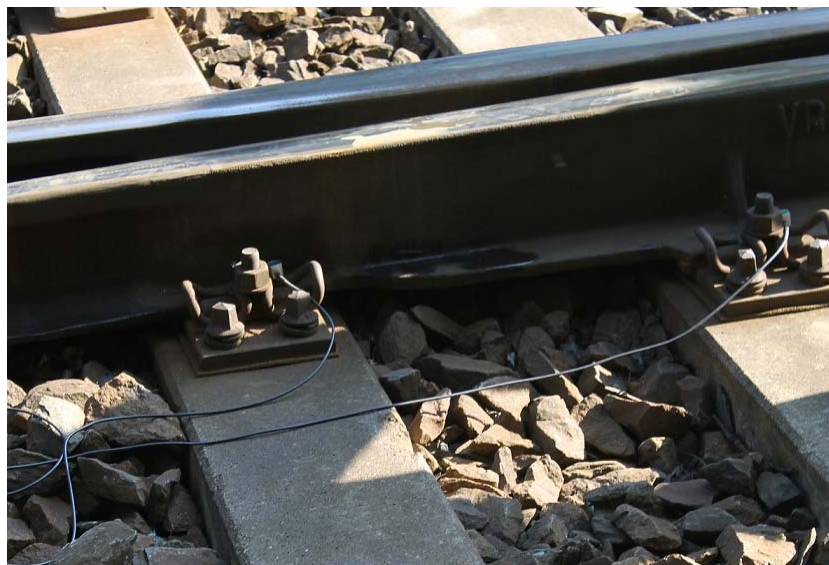
Kuva 35. Radan palautuvaa painumaa mittaavat kiihtyvyyssanturit.
