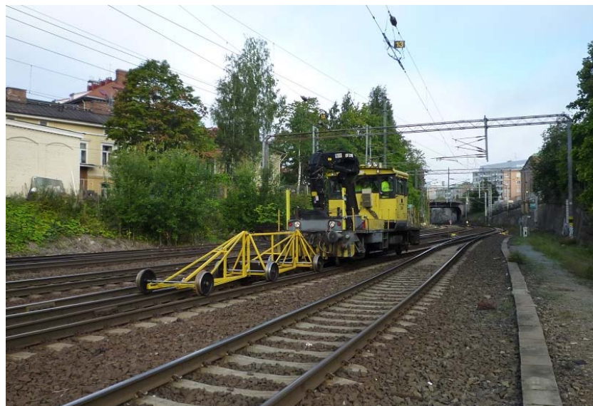
Kuva 33. TTY:llä kehitetty radan palautuvaa painumaa mittaava vaunu.
