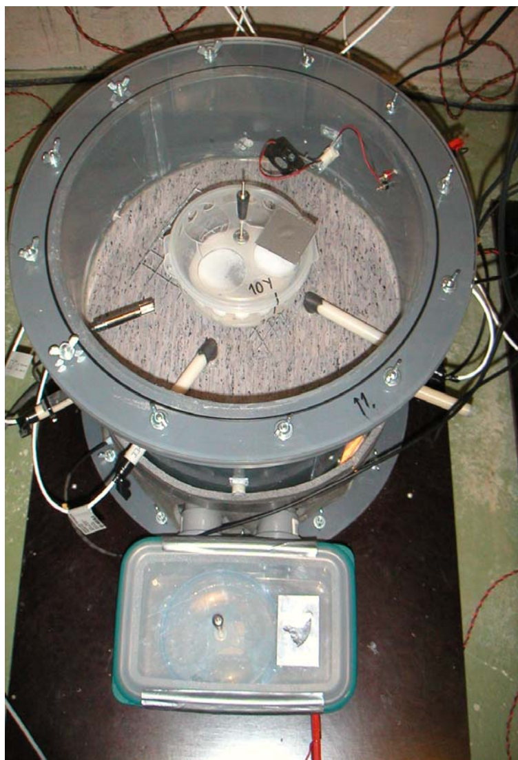
Kuva 15. Suola-astia yläilmatilassa ja sivukammio alailmatilasuolalle.
