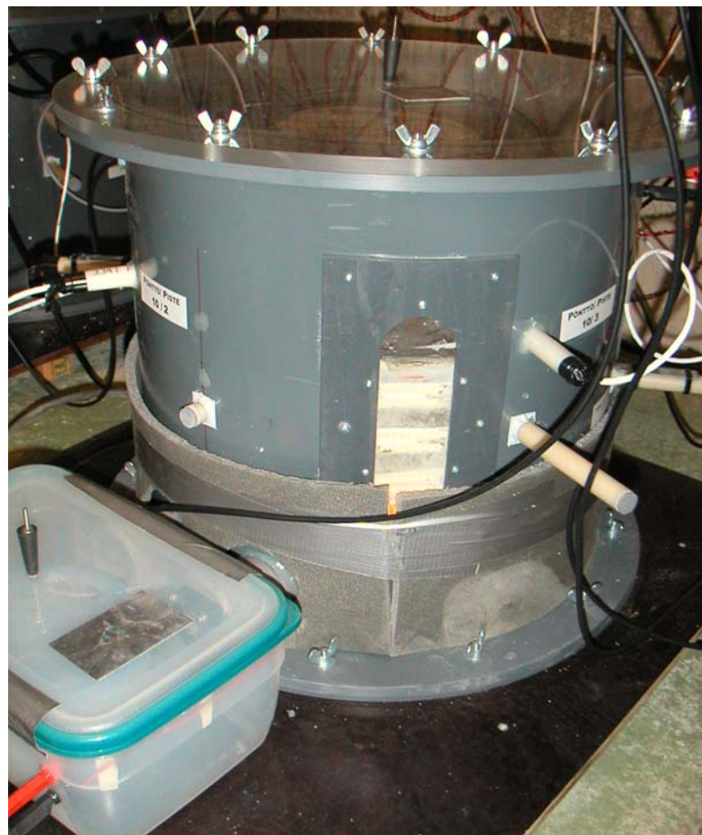
Kuva 17. Lisälämmitys ja lämmöneriste.
