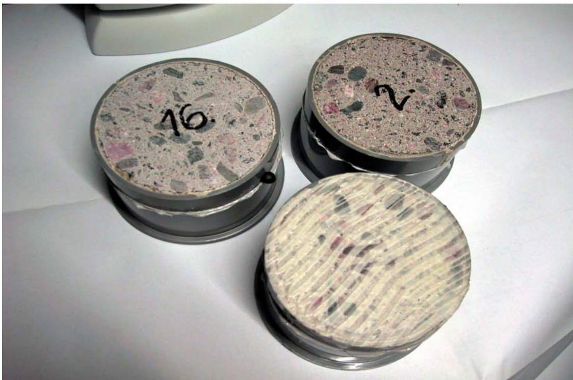
Kuva 54. Liima- ja dispersiokoekappaleet. Kammattu pinta on liimaa. Dispersiökäsitellyn koekappaleen tunnus on 2. Tunnuksella 16 varustettu kappale on pelkkää betonia.
