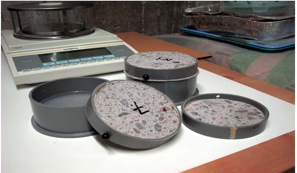
Kuva 5. Kuppikokeissa käytettävän kupin rakenne. Vasemmalla kylläistä suolaliuosta sisältävä kuppi ilman kansiosaa, keskellä kansiosia, joihin liimattuina tutkittavat materiaalit ja takana valmis kuppi.
