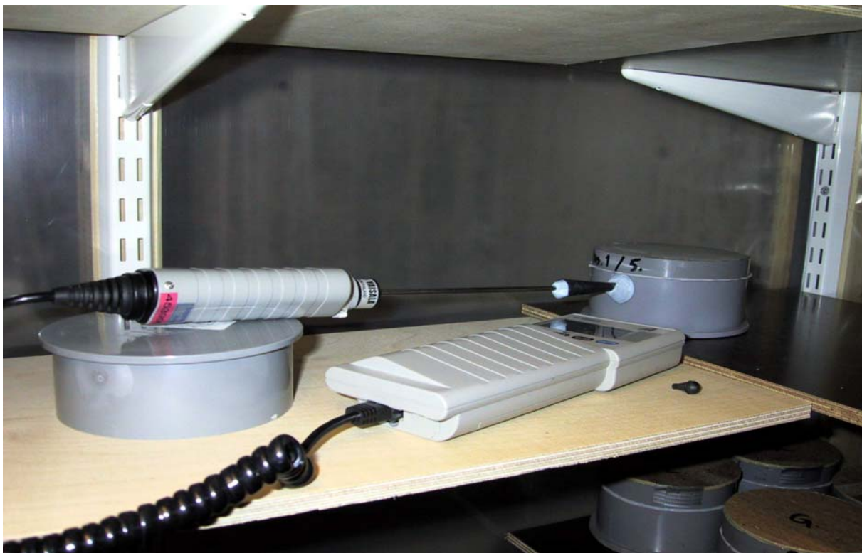
Kuva 8. RH-mittaus käynnissä kupin sisällä vallitsevan todellisen suhteellisen kosteuden selvittämiseksi.
