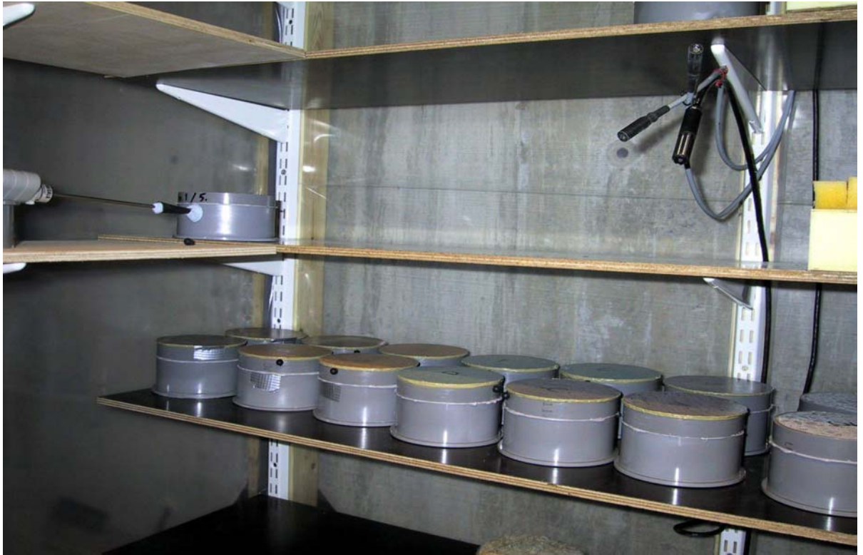
Kuva 7. Yleisnäkymä kosteussäilytyshuoneesta. Vasemmalla mitataan Vaisala HMP42 – mittapäällä kupin sisällä vallitsevaa todellista suhteellista kosteutta.
