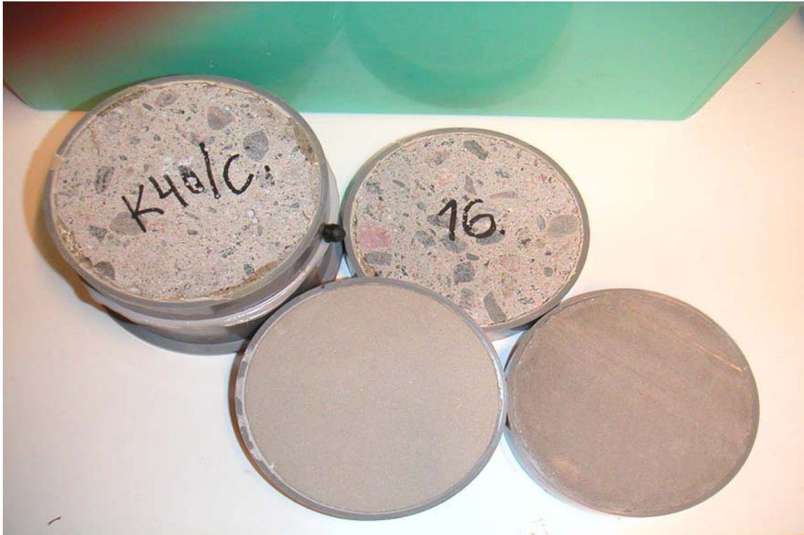
Kuva 55. Edessä vasemmalla (vaaleampi) tasoite Vetonit 3000 ja oikealla (tummempi) Vetonit 1500. Takana vas. tunnuksella K40/C on betonia NP40 ja oik. tunnuksella 16 betonia K30.
