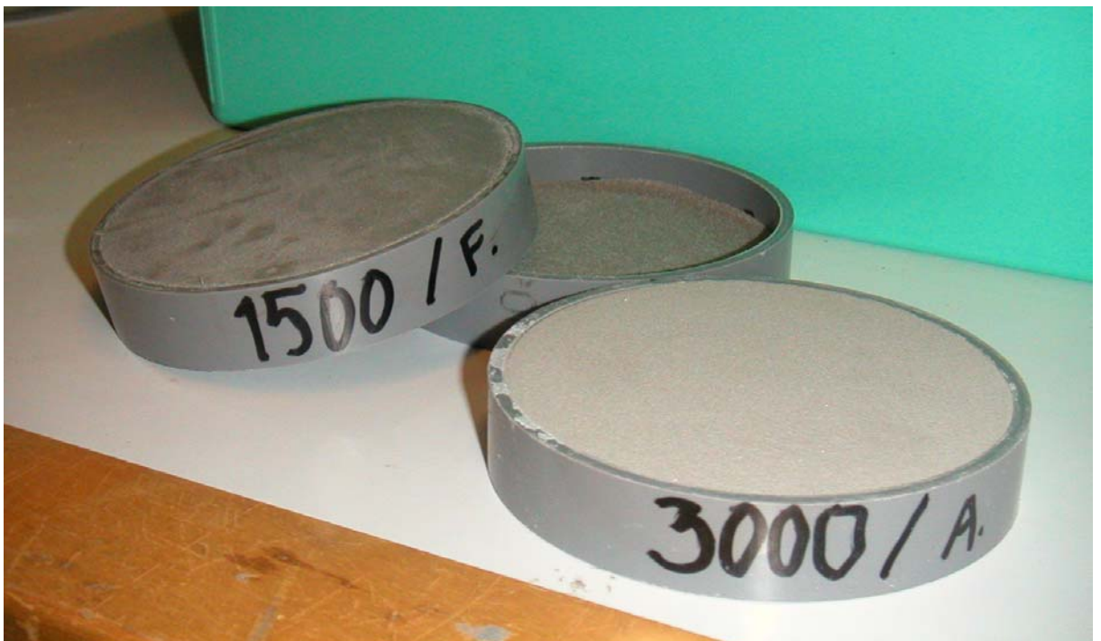
Kuva 6. Tasoitekoekappaleet. Vetonit 1500 ja Vetonit 3000.
