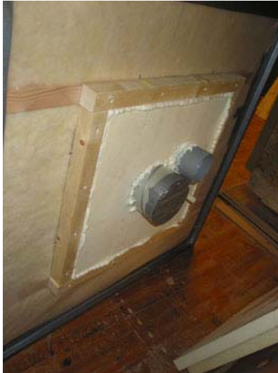
Kuva 4.3.4 Kahdella tiivistyslevyllä toteutetuissa kokeissa testattiin sekä yksittäinen läpivienti että kolmen putken yhdistelmä (vasemmalla). Molemmissa kokeissa tulokset olivat hyviä (oikealla).
