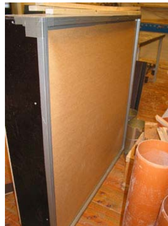
Kuva 4.2.1 Kokeissa 1 ja 2 määritettiin ehjän höyrinsulkumuovin ja paperipohjaisen ilmansulun ilmanpitävyys.
