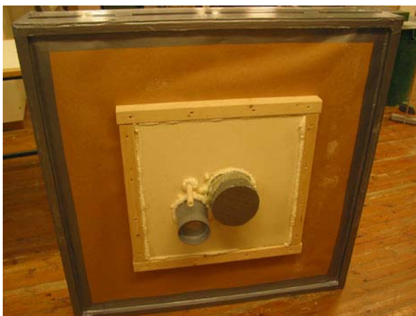
Kuva 4.3.5 Viimeisissä PUR-kauluksella toteutetuissa kokeissa tiivistyslevy asennettiin vain ilmansulun etupuolelle (vasemmalla). Kolmen putken läpivientien ilmanpitävyys oli heikompi kuin yksittäisten putkien (oikealla).
