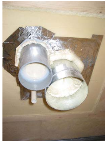
Kuva 4.1.2 Yksittäisten putkien läpiviennissä putkena oli \varnothing 160 mm kierresaumattu IV-putki (vasemmalla). Kolmen putken läpiviennissä tämän viereen lisättiin \varnothing 110 mm tuuletusviemäriputki sekä \varnothing 20 mm sähköputki (oikealla). Läpivientiputket vaahdotettiin sisältä polyuretaanivaahdolla tai kitattiin tiiviiksi. Kuvat ovat koekappaleista 11 ja 12.
