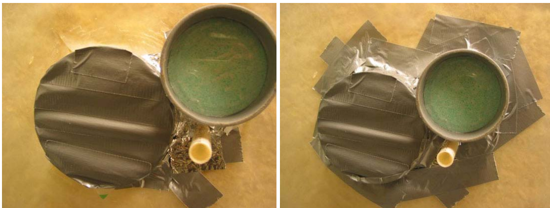
Kuva 4.2.4 Putkien väliä yritettiin tiivistää alumiiniteipillä (vasemmalla). Teippauksia paranneltiin useasti, mutta kolmen putken läpivientikokeesta ei teippaamalla saatu hyväksyttävää tulosta (oikealla).
