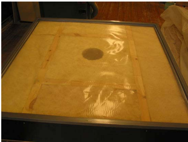
Kuva 4.2.1 Kokeissa 1 ja 2 määritettiin ehjän höyrinsulkumuovin ja paperipohjaisen ilmansulun ilmanpitävyys.
