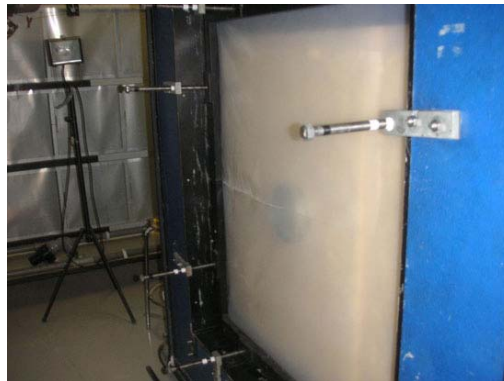
Kuva 4.1.3 Kalibrointia varten koekappaleen taustapintaan tiivistettiin ehjä höyrynsulkumuovikalvo (vasemmalla). Koekappale asennettiin kalibrointia varten rakennusfysikaaliseen laitteistoon ja mitattiin koejärjestelyn alkuperäinen ilmavuoto eli kalibrointi-arvo (keskellä). Kokeessa kalibrointikalvo leikattiin auki läpiviennin kohdalta (oikealla).
