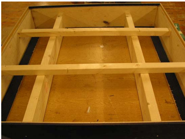
Kuva 4.1.1 Koekappaleen kehikko mallinsi puurankarakennetta (vasemmalla). Asennus rakennusfysikaaliseen tutkimuslaitteistoon toteutettiin puristamalla koekappale aukon tiivisteitä vasten sekä tiivistämällä koekappaleen reunat teipillä (oikealla).
