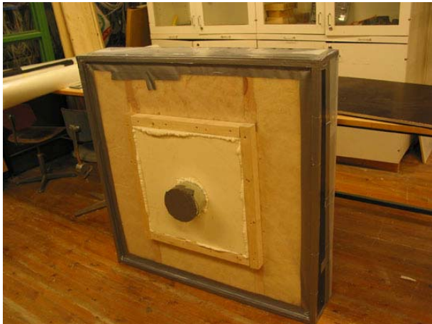
Kuva 4.1.2 Yksittäisten putkien läpiviennissä putkena oli \varnothing 160 mm kierresaumattu IV-putki (vasemmalla). Kolmen putken läpiviennissä tämän viereen lisättiin \varnothing 110 mm tuuletusviemäriputki sekä \varnothing 20 mm sähköputki (oikealla). Läpivientiputket vaahdotettiin sisältä polyuretaanivaahdolla tai kitattiin tiiviiksi. Kuvat ovat koekappaleista 11 ja 12.
