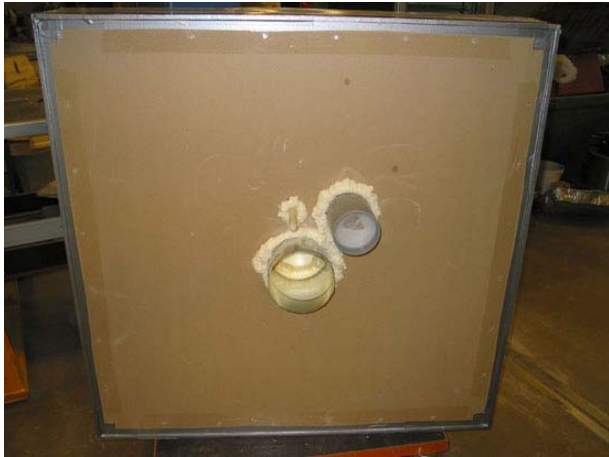
Kuva 4.4.2 Viimeisissä PUR-kauluksella toteutetuissa kokeissa tiivistyslevy asennettiin vain ilmansulun etupuolelle (vasemmalla). Kolmen putken läpivientien ilmanpitävyys oli hieman heikompi kuin yksittäisten putkien (oikealla).
