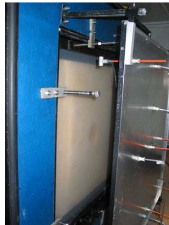
Kuva 4.1.1 Koekappaleen kehikko mallinsi puurankarakennetta (vasemmalla). Asennus rakennusfysikaaliseen tutkimuslaitteistoon toteutettiin puristamalla koekappale aukon tiivisteitä vasten sekä tiivistämällä koekappaleen reunat teipillä (oikealla).
