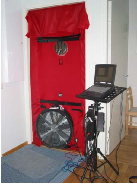
Kuva 2.2.1 Painekoelaitteisto asennettuna asunnon oveen kerrostalossa.
