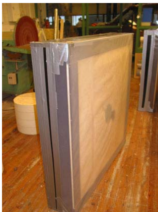
Kuva 4.1.3 Kalibrointia varten koekappaleen taustapintaan tiivistettiin ehjä höyrynsulkumuovikalvo (vasemmalla). Koekappale asennettiin kalibrointia varten rakennusfysikaaliseen laitteistoon ja mitattiin koejärjestelyn alkuperäinen ilmavuoto eli kalibrointi-arvo (keskellä). Kokeessa kalibrointikalvo leikattiin auki läpiviennin kohdalta (oikealla).
