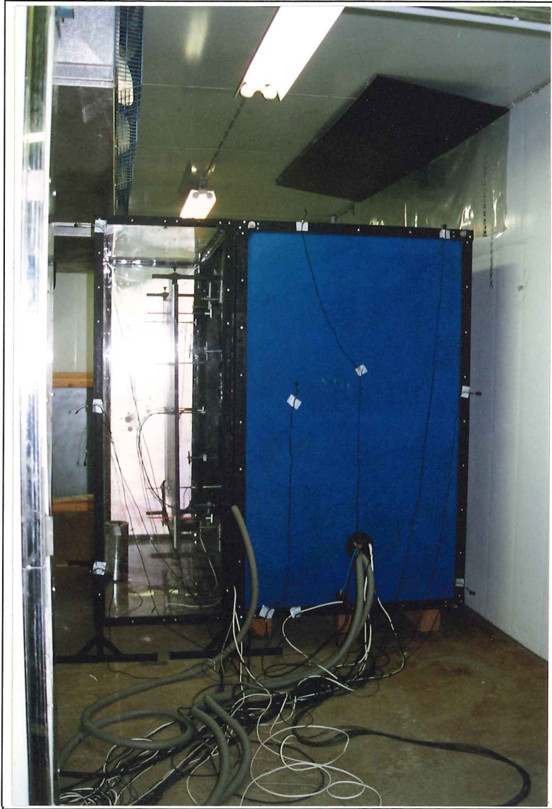
Kuva 2.2. TTKK:n rakennusfysikaalisen tutkimuslaitteiston lämmin kammio ja suojakammio pakkahuoneeseen sijoitettuina.
