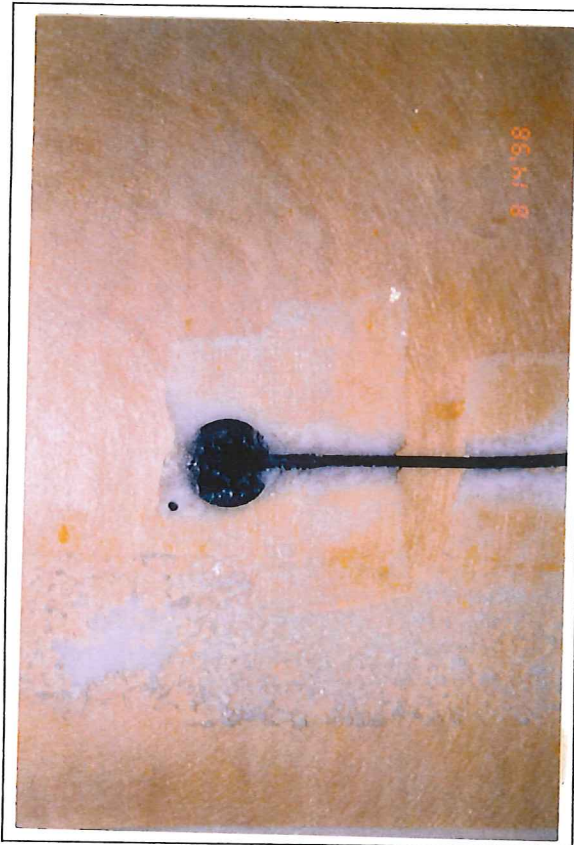
Kuva 5. Koeseinässä 4 jäätä muodostui lämpötila-anturien kiinnittämiseen käytetyn teipin alle tuulensuojalevyn ulkopinnalle (katselusuunta toisinpäin).
