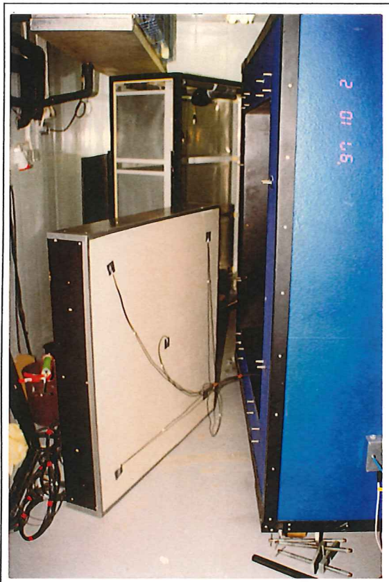
Kuva 1. Valmiin koeseinän sisäpintaan asennettiin pintalämpötila-anturit. Koeseinä oli tämän jälkeen valmis asennettavaksi tutkimusaukkoon.
