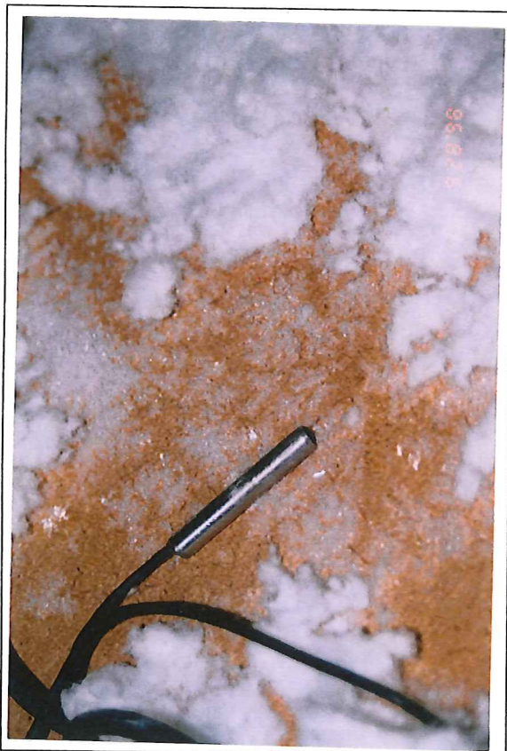
Kuva 7. Koeseinässä 8 kondensoituminen tuulensuojalevyn taakse oli voimakasta (katselusuunta toisinpäin).
