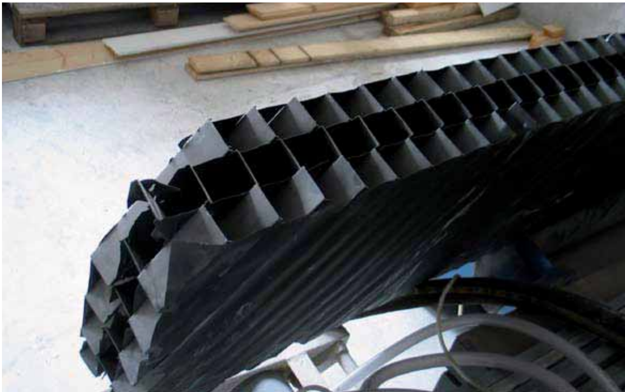
Kuva 7.3. Lukkarinrannan vedenkäsittelylaitosta tehostettiin vuonna 1972 putkiselkeyttimillä. (Katko 2009)
