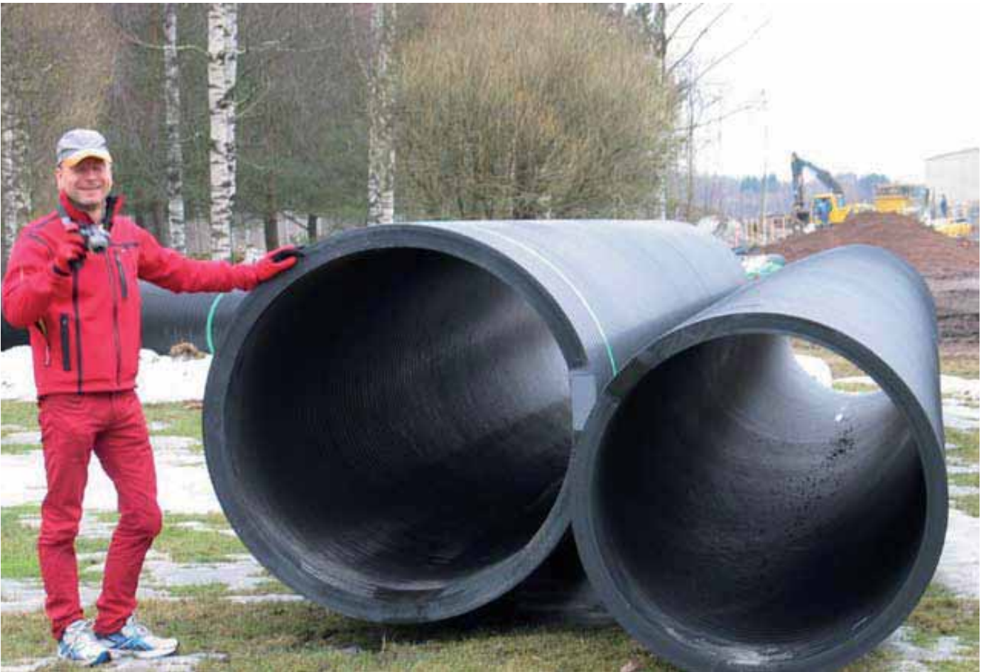
Kuva 8.15a ja b. Luotsinmäen jätevedenpuhdistamon käyttöön jäävä purkuviemäri sekä puhdistamoalueella käytettävä kerrosrakenteinen viemäriputki ja Petri Juuti. (Katko 2009)
