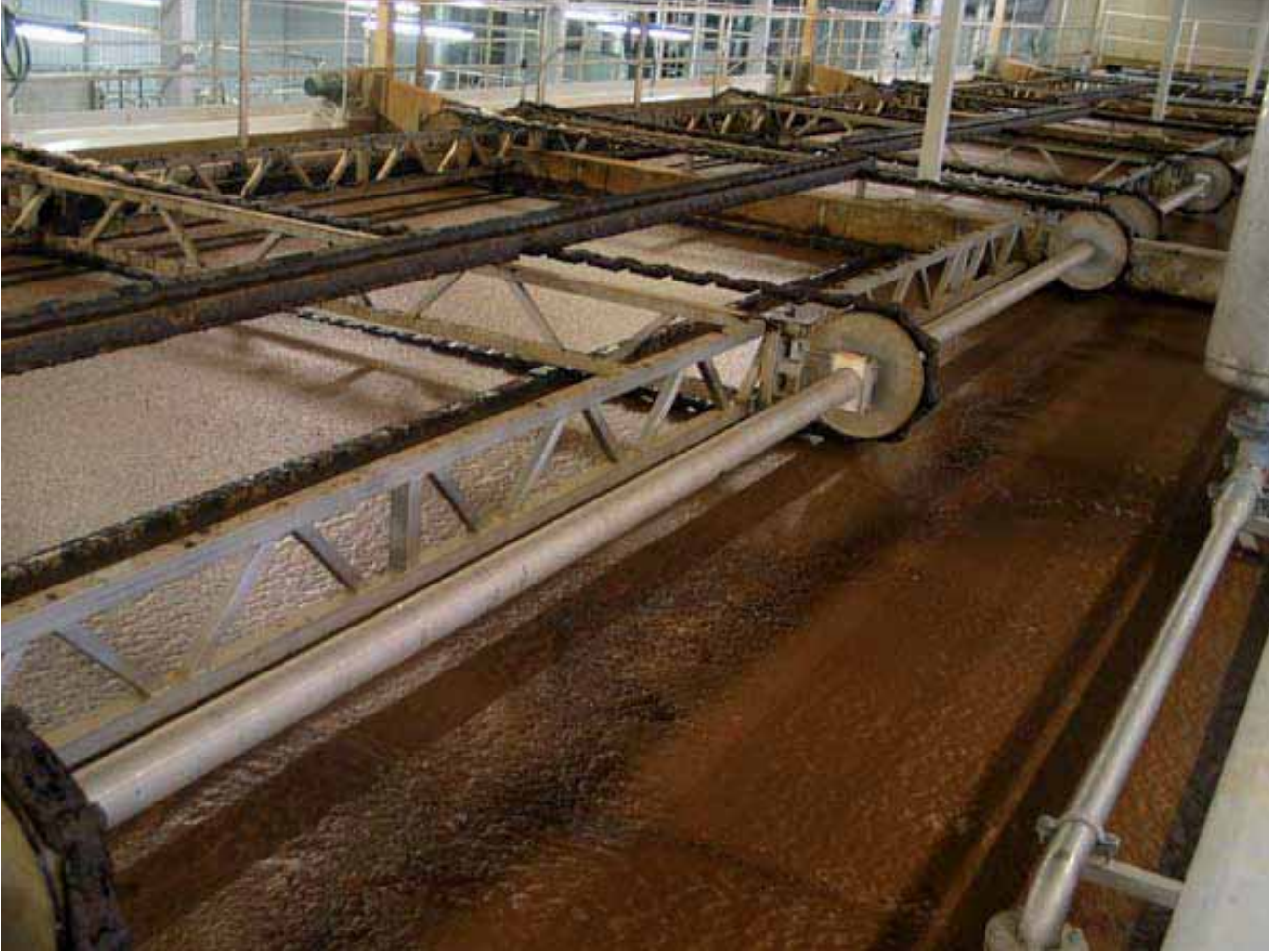
Kuva 7.23a ja b. Harjakankaan laitoksen flotaatioaltaat ja laahaimet (Katko 2009).
