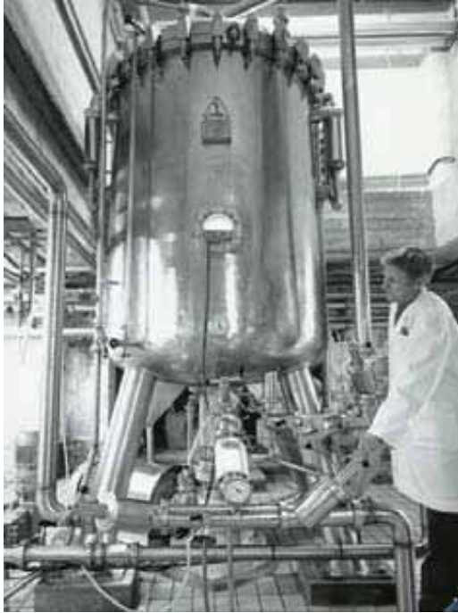
Kuva 7.7. Porin oluttehtaan uusi pii- maasuodatin vuodelta 1973 ja pani- momestari Georg Orlow. ( http:// www.sinebrychoff.fi/page.php?page_ id=593 ).
