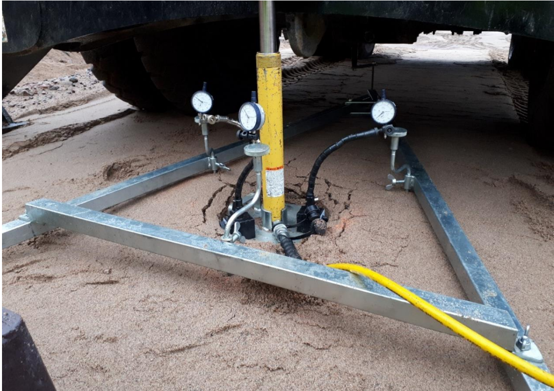
Kuva 6.11: Koepenkereen C levykuormituskoe
