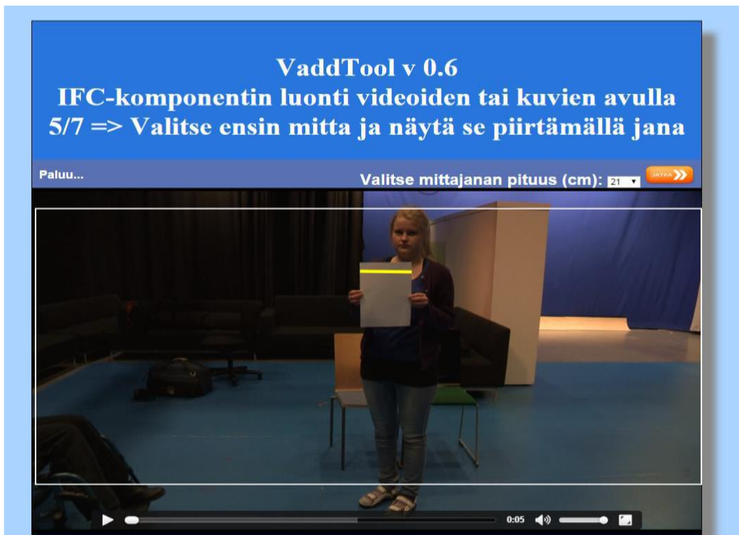
Kuvio 17. Kuvassa ollaan kalibroimassa erään dimension mitoitusta A4-paperiarkista otetun videokuvan avulla (A4-paperiarkin leveys on 21 cm).
