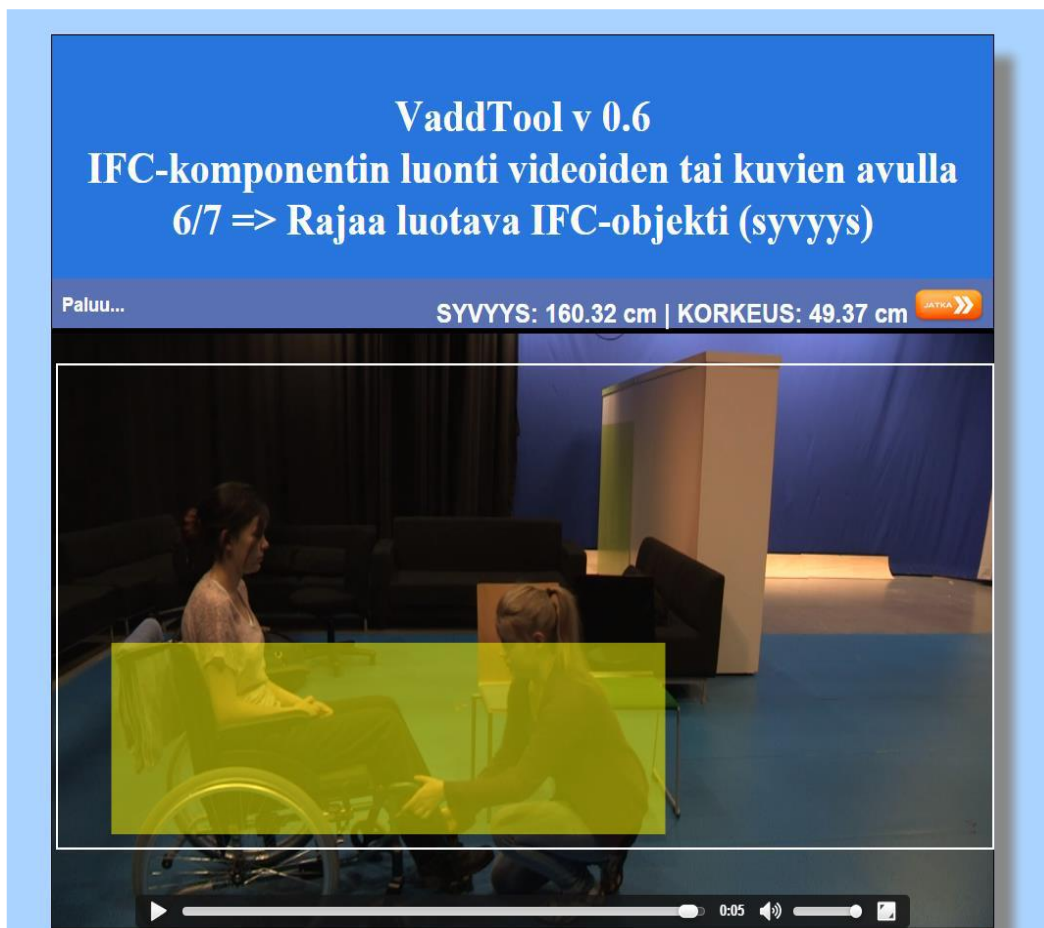
Kuvio 18. Kuvassa mitoitetaan valitun toiminnon syvyysuuntaista tilantarvetta, joka näyttäisi tässä mitoituksen vaiheessa olevan hieman yli 160 cm. Korkeussuuntainen mittalukema on tässä vain apuna, eikä sillä ole merkitystä mitoituksen kannalta.
