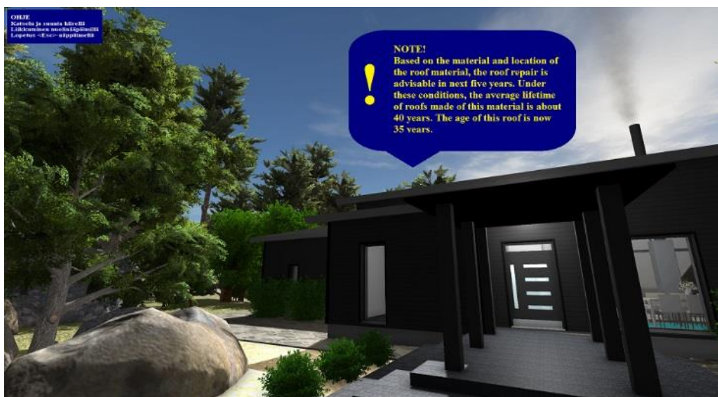
Kuvio 33. Rakennuksen pelillistetyn tietomallin päälle tehty rakennuksen digitaalinen kaksonen joka ilmoittaa, että vertailudatan perusteella katto alkaa olemaan korjauksen tarpeessa.
