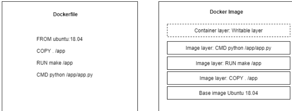
Kuva 4. Dockerfile ja sen luomat kerrokset Docker-kuvassa.
