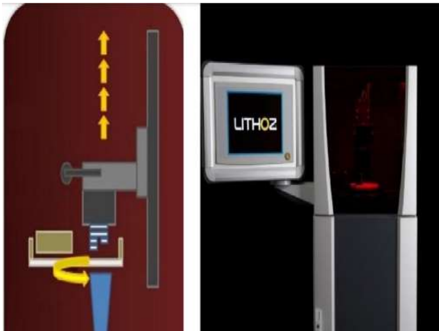
Kuva 3. Cerafab 7500 -tulostin ja toimintaperiaate [16]
