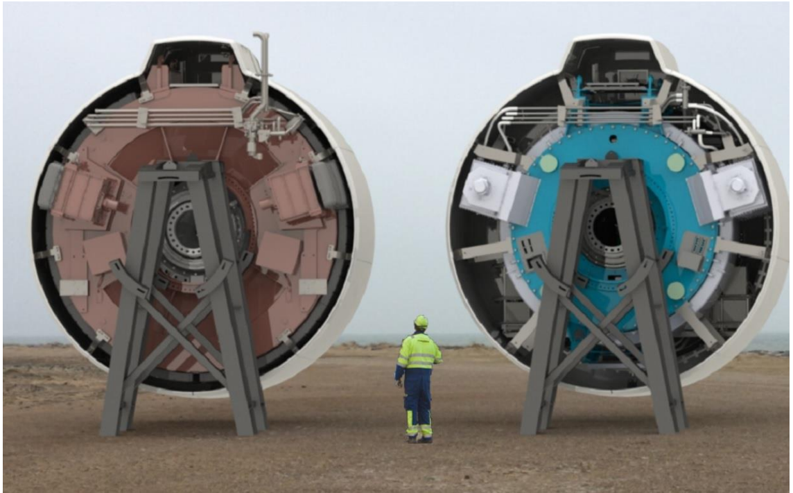
Kuva 17 Kestomagneettigeneraattorin (vasemmalla) ja suprajohdegeneraattorin (oikealla) kokoverailu [17].
