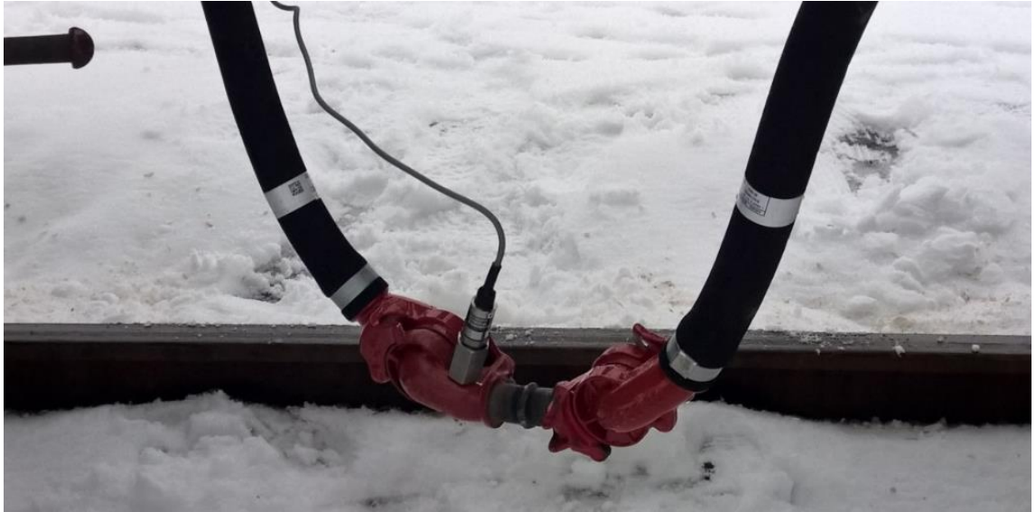
Kuva 26. Jarrujohdon mittaus toteutettiin letkuliittimestä
