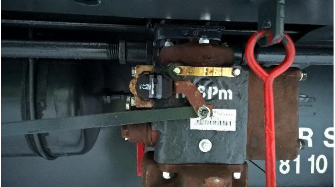
Kuva 29. Jarrulajiasettimen asennon mittaus anturin kulmasta y-akselin suhteen
