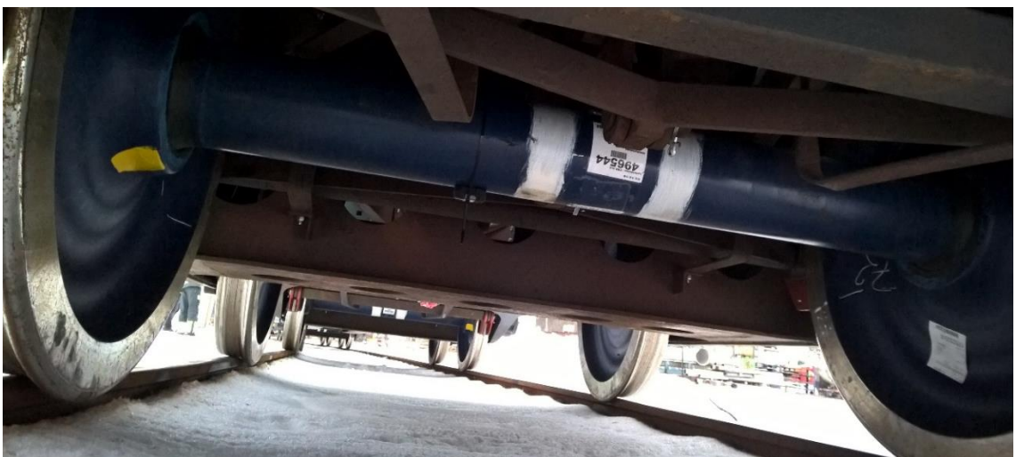
Kuva 31. Akselin pyörinnän mittaus kulmalla anturin x-akselin suhteen
