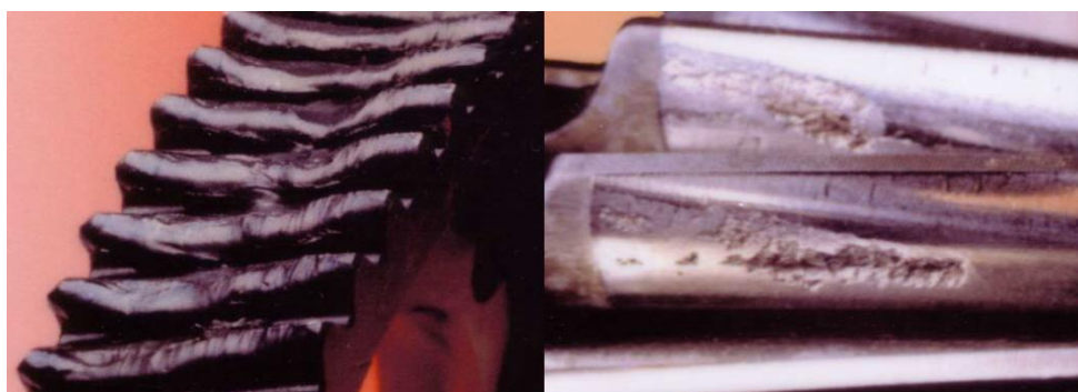
Kuva 11. Hammasrattaiden käytöstä johtuvaa kulumista. [13]
