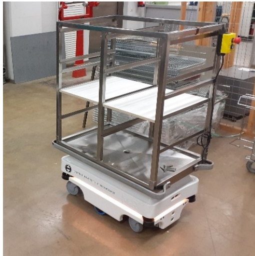
Kuva 10. Välinehuoltovaunua kantava MiR100-robotti.
