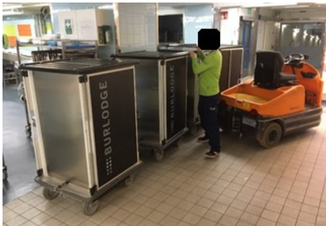
Kuva 20. Keittiöön palautettuja ruoankuljetusvaunuja. Vetotrukin perässä voidaan vetää vakuutusyistä maksimissaan kolmea ruoankuljetusvaunua kerrallaan.
