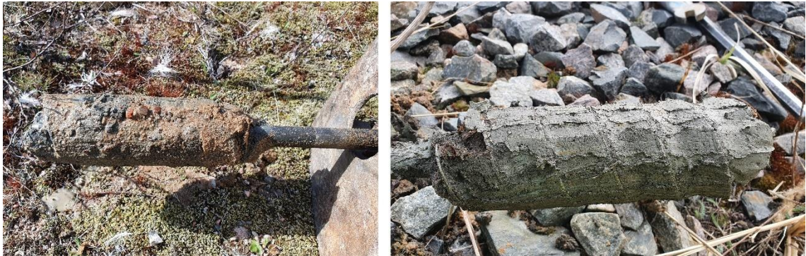
Kuva 42. Savinäyte, vasemmalla ennen irtomaan puhdistusta ja oikealla puhdistettu näyte.
