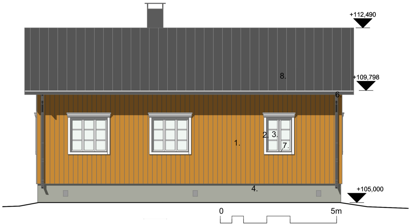
Kuva 61 Julkisivu koilliseen, Puutikkalan talo, 1:100
