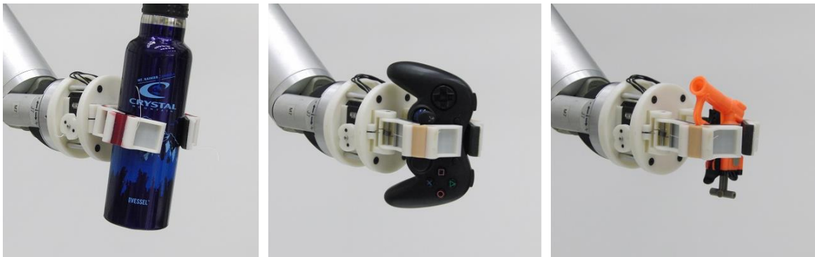
Kuva 21: Yale-yliopiston OpenHand-projektin monikäyttöinen, mukautuva Model T42 -tarrain (mukaillen Yale University, verkkosivu).
