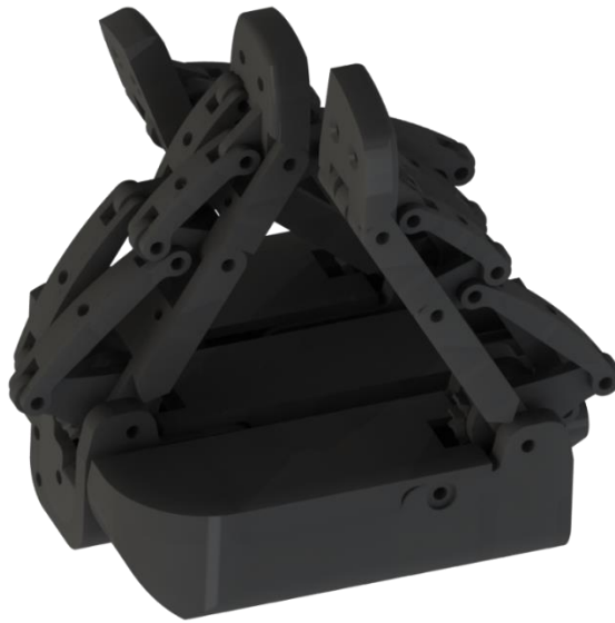
Kuva 22: SolidWorksilla renderöity kuva tarraimen 3D-mallista.
