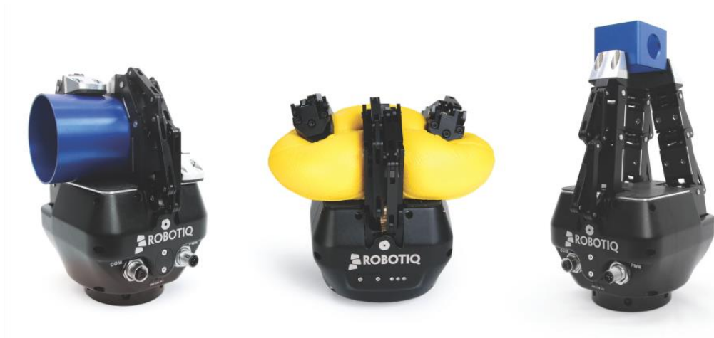
Kuva 5: Adaptiivinen eli mukautuva sähköinen tarrain (Robotiq, verkkosivu).
