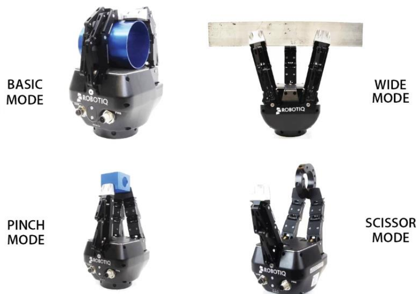
Kuva 14: Mukautuva, kolmisorminen tarrain ja sen eri tartuntatyylit (mukaillen Robotiq, verkkosivu).
