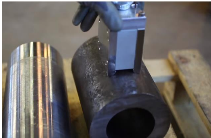
Kuva 8: Magneeteilla voidaan tarttua myös pyöreisiin ja epätasaisiin kappaleisiin (mukaillen Ixtur [b], verkkosivu).
