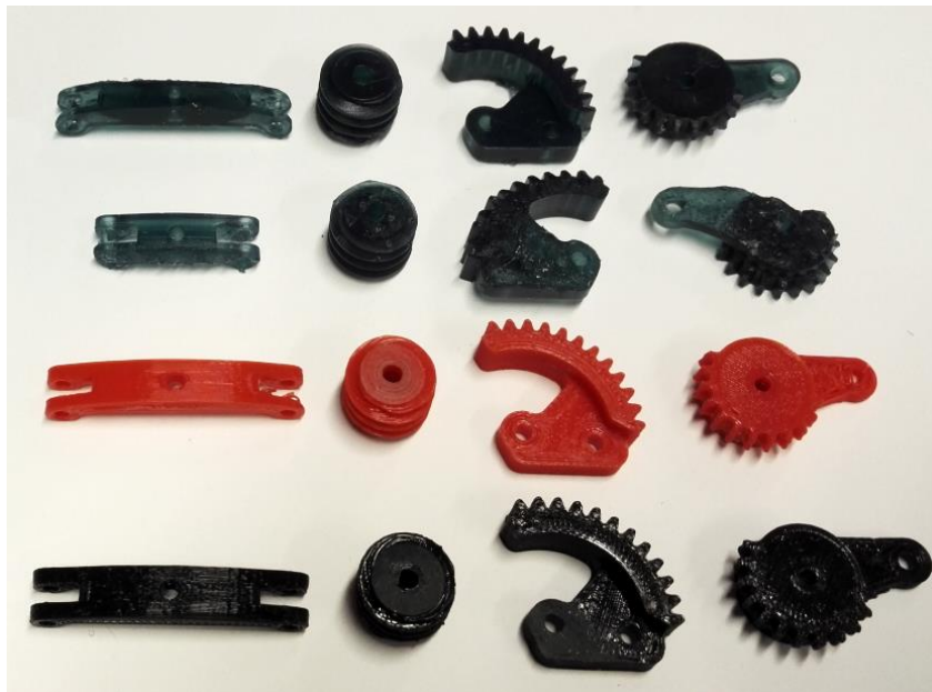
Kuva 24: SLA- ja FDM-tekniikoilla tulostettuja tarraimen osia. Ylimmäisinä olevissa sinertävissä SLA-tulosteissa ilmeni epämuodostumia. Punaiset osat ovat ABS-muovia ja mustat PLA:ta.
