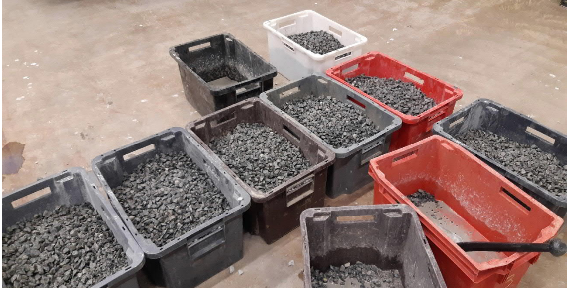
Kuva 52. Louhoksen B lajitteen 8/16 mm jakaminen alkamassa.
