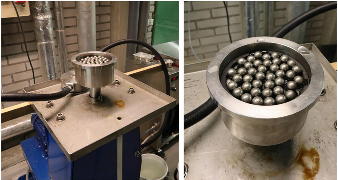
Kuva 70. Näyte asetettuna Prall-laitteeseen.
