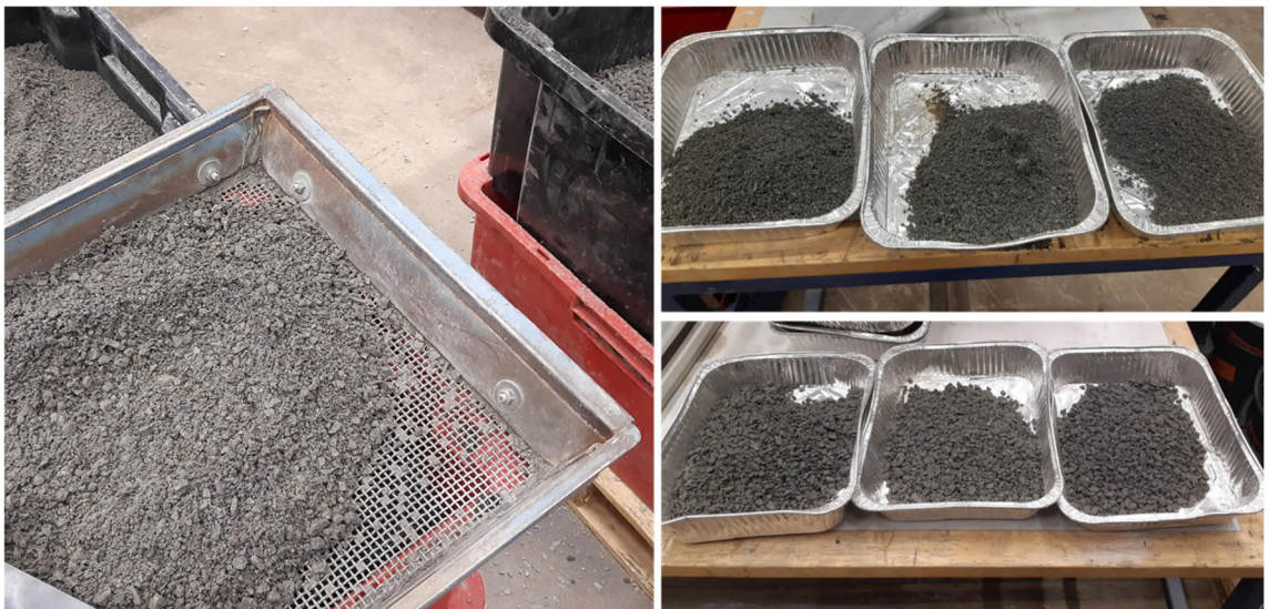
Kuva 51. Lajitteen 0/8 mm katkaiseminen 4 mm seulalla ja testinäytteet 0/4 ja 4/8 mm lajitteista.
