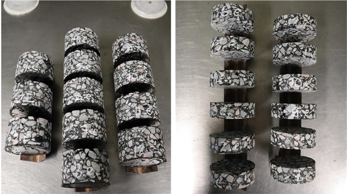
Kuva 69. Porakappaleet ja sahatut näytteet.
