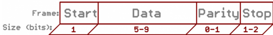
Kuva 3.3. Asynkronisessa ja synkronisessa tiedonsiirrossa käytetyn paketin rakenne. [9]
